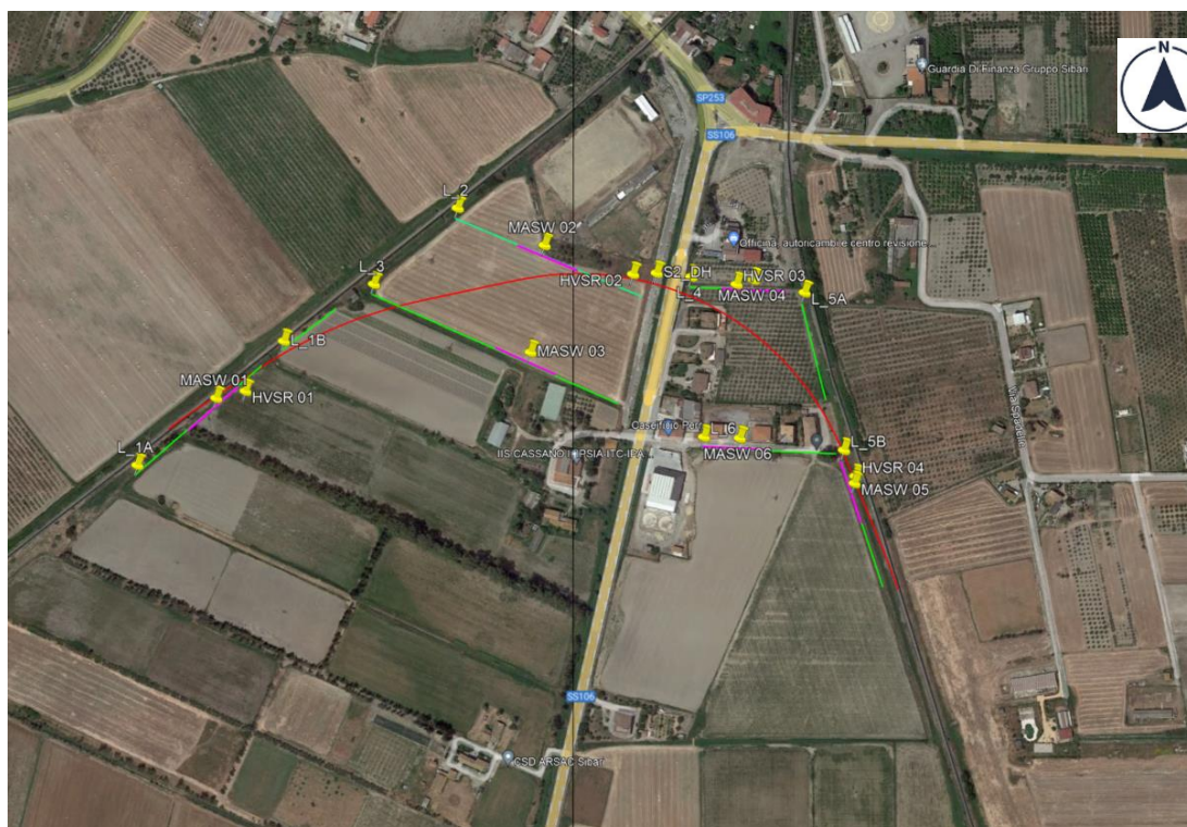
Figura 4.1 – Immagine aerea dell'area di studio, con ubicazione delle indagini eseguite, in rosso il tratto ferroviario in progetto.
