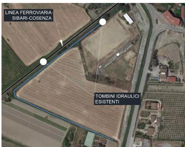
*Figura 2 – inquadramento tombini idraulici esistenti sotto binario, linea Sibari-Cosenza*
