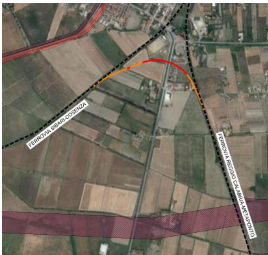
Figura 2 Stralcio Planimetrico Vincolo PAI e PGRA, estratto dall'elaborato di progetto RC2V00R14P5ID0000001A a cui si rimanda
