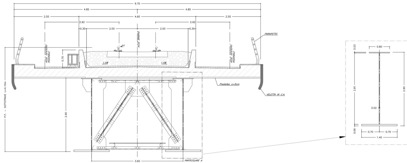
SEZIONE TRASVERSALE L=30m SINGOLO BINARIO
