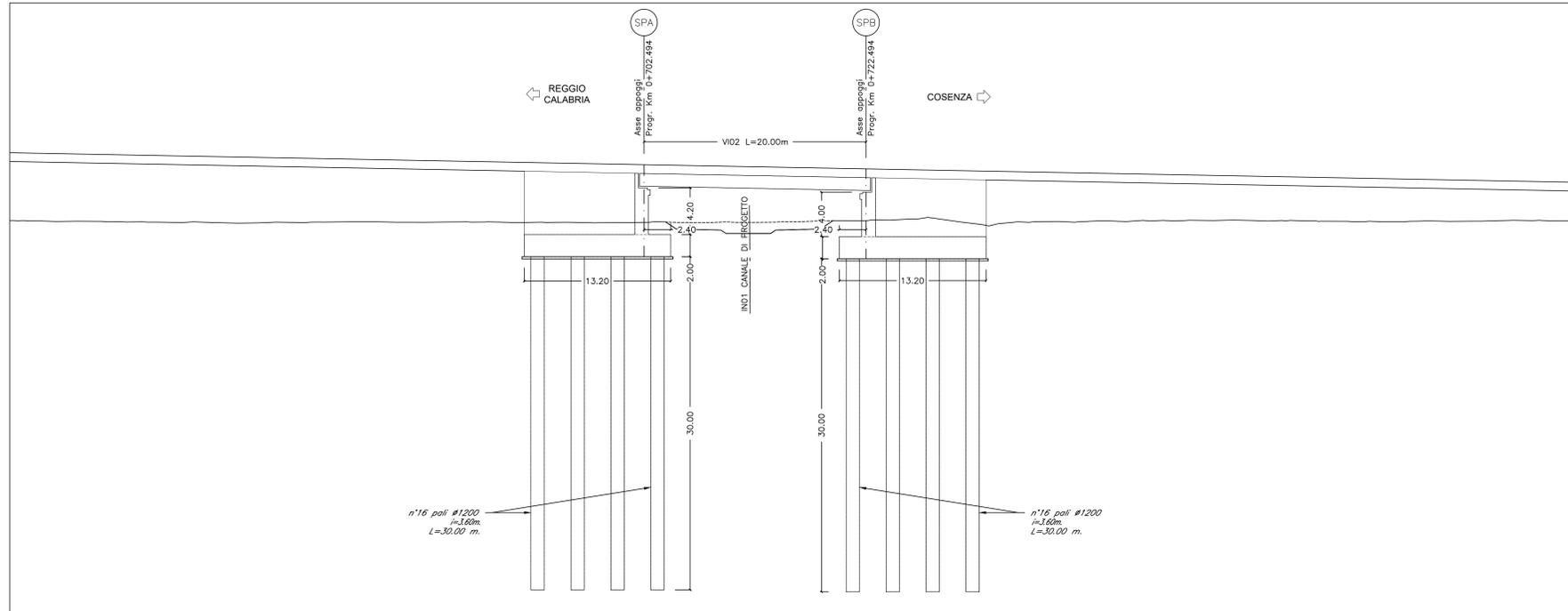
SEZIONE TRASVERSALE SPALLA
