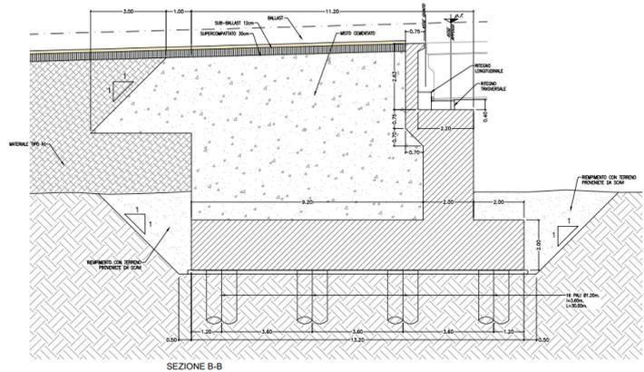
**5: Sezione e prospetto spalle VI01**
