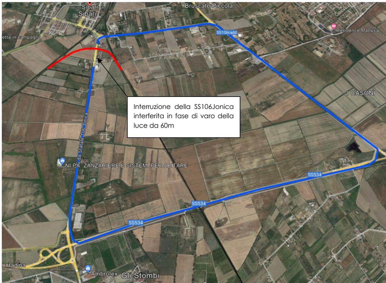
Rappresentazione della viabilità alternativa in fase di varo dell'impalcato a travata metallica a via inferiore per lo scavalco della SS106Jonica
