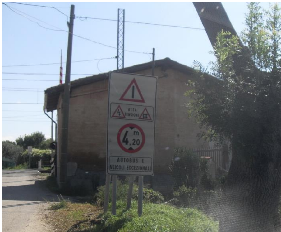
Vista dalla SP64 del cartello di limite sagoma a 4,20 m per i fili elettrici della TE
