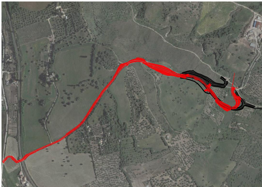
Figura 14 – Stralcio planimetrico con indicato in nero la viabilità di progetto NV04 presentata nel Progetto definitivo e in rosso quella del Progetto Esecutivo
