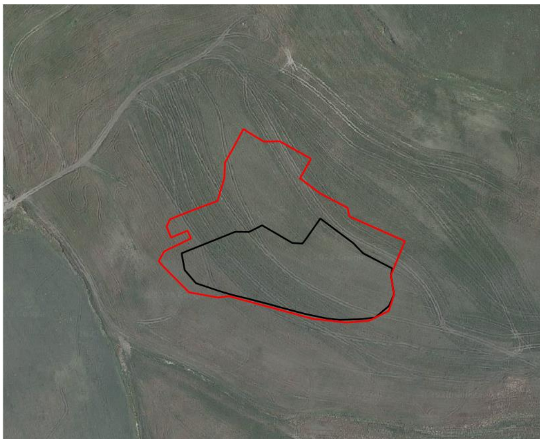
Figura 8 – Stralcio planimetrico con indicato in nero il perimetro dell'Area di Stoccaggio AS.03 presentato nel Progetto definitivo e in rosso il perimetro dell'imbocco del Progetto Esecutivo
