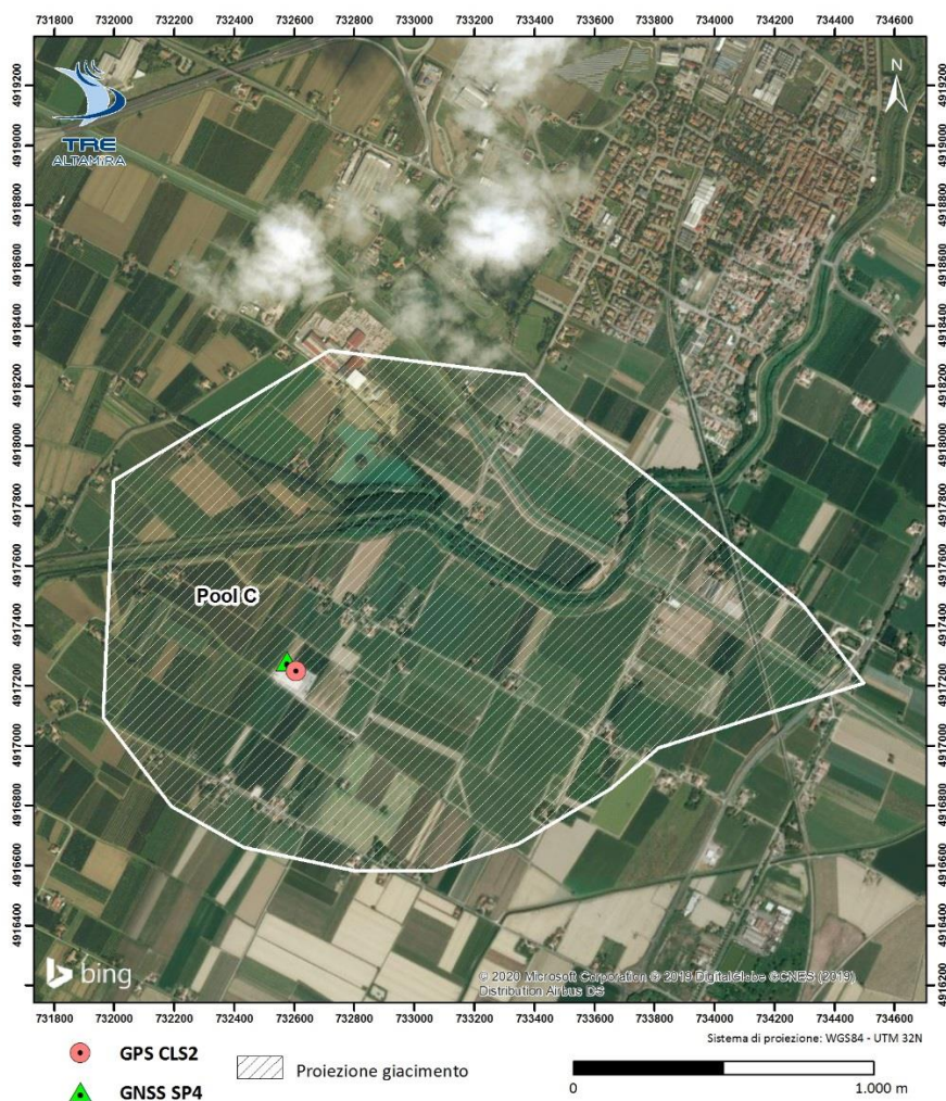
Figura 34: Posizione della stazione GPS – CLS2 attiva da gennaio 2014 attigua alla stazione GNSS SP4 attiva dal 2018.
