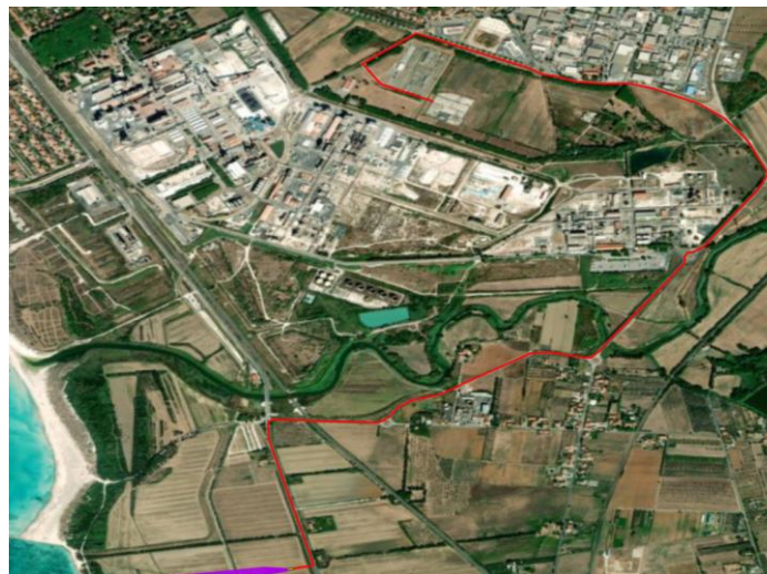
Figura 4-15: Percorso preliminare cavidotto a 220 kV
