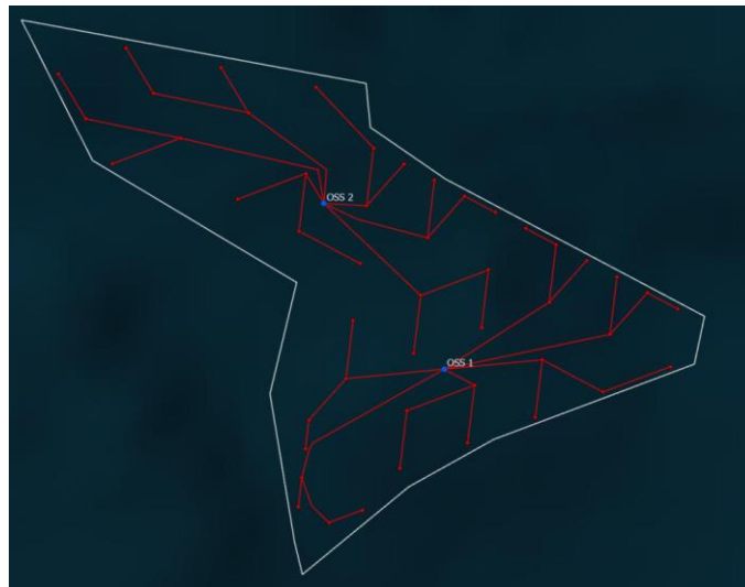
Figura 4-3: Collegamenti in stringa degli aerogeneratori
