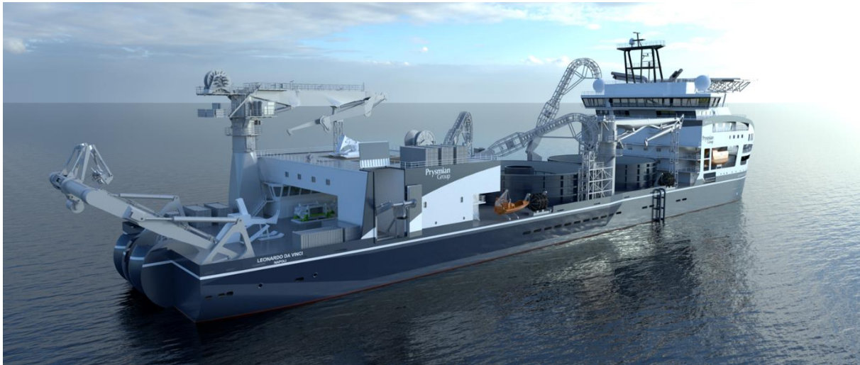
Figura 4-13: Nave posa cavo Leonardo Da Vinci (Fonte: Prysmian Group/Fincantier)
