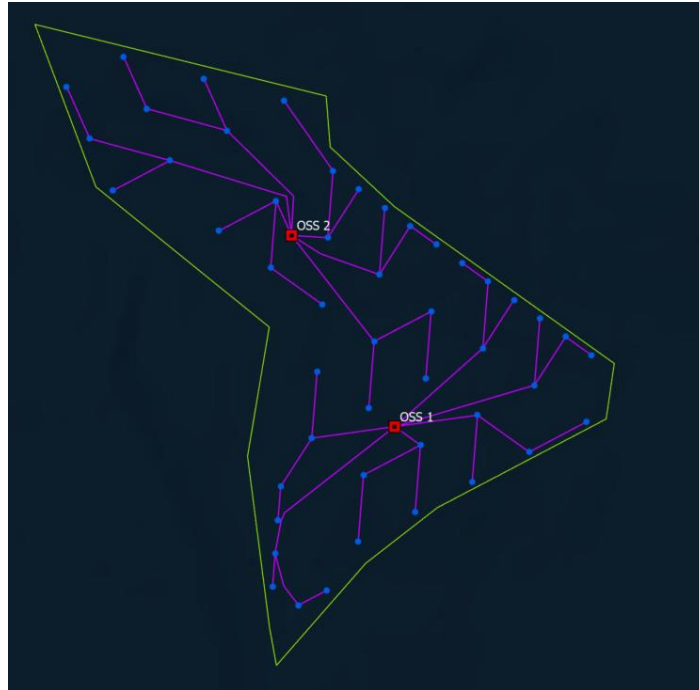
Figura 4-3: Collegamenti in stringa degli aerogeneratori
