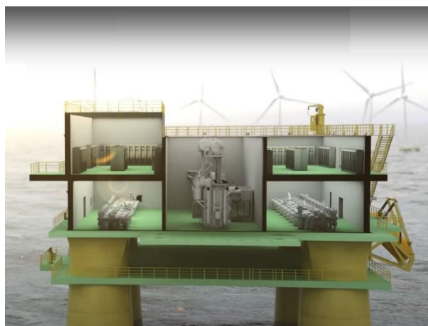
Figura 3-2: Esempio di OSS semi-sommersibile a pianta quadrata
