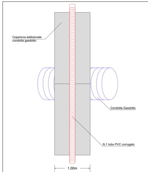
SEZIONE ATTRAVERSAMENTO GASDOTTO
