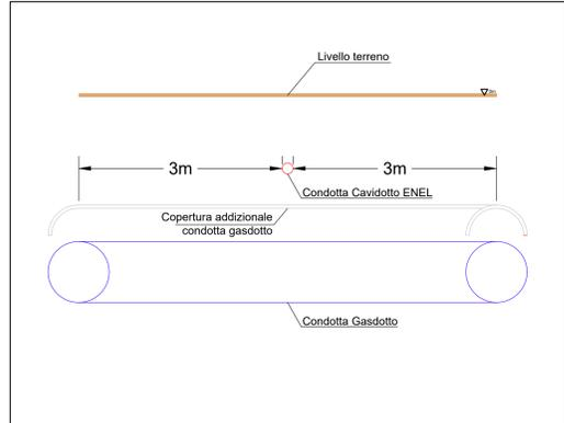
SEZIONE ATTRAVERSAMENTO GASDOTTO
