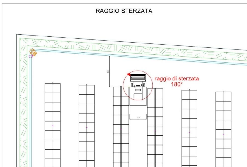
Figura 7. Rappresentazione del raggio di sterzata del macchinario per la trebbiatura
