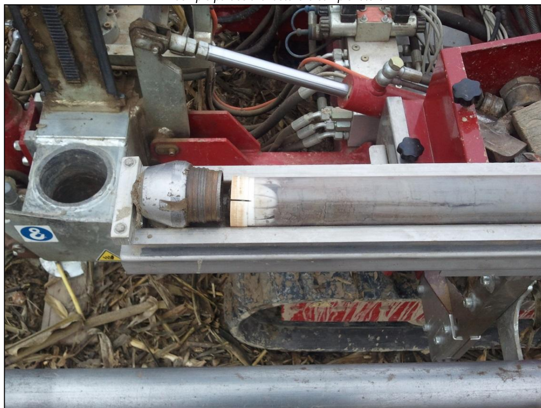
Esempio estrazione fustella con terreno
