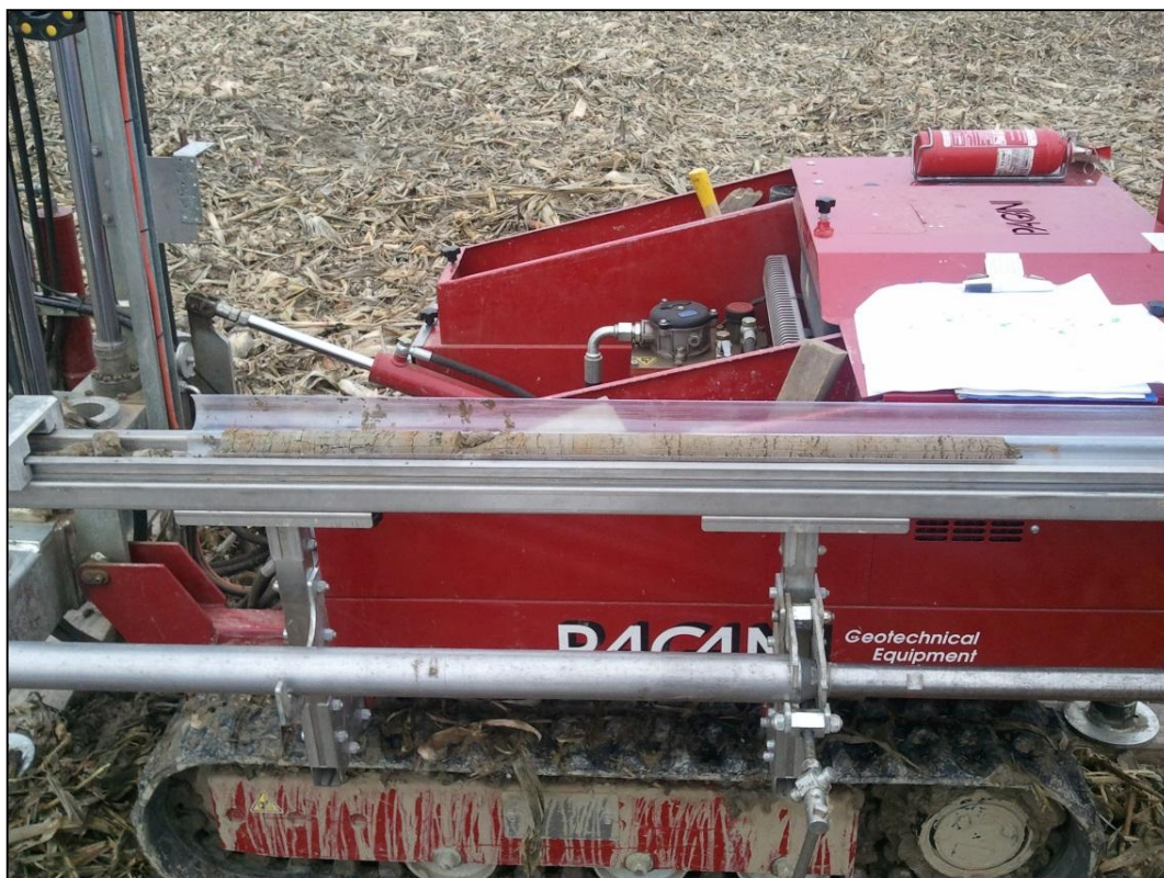
taglio fustella in pvc e prelievo terreno
