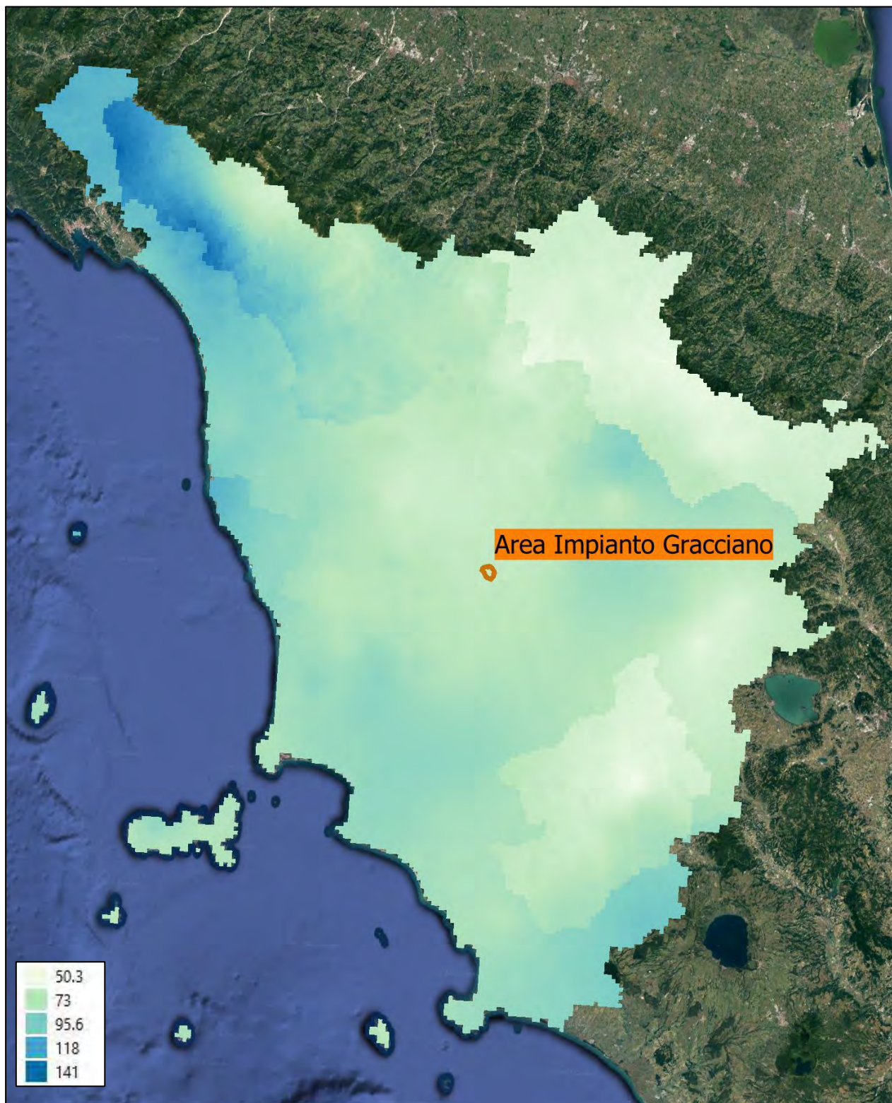
Figura 3.20: Metodo regionalizzazione dell'Università degli Studi di Firenze: esempio distribuzione parametro a delle LSPP, per l'intero territorio della Regione Toscana, nella condizione T_r 200 anni e ubicazione del bacino del Torrente di Scarna chiuso in prossimità dell'area d'intervento
