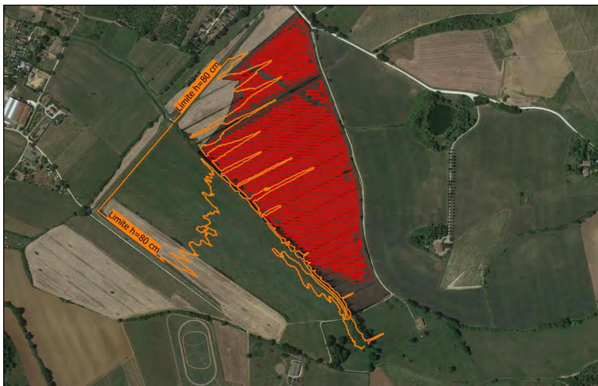
Figura 4.39: Torrente di Scarna, modello bidimensionale in moto vario (unsteady-flow): limite dei tiranti a 0.80 mt sul piano campagna estratto dai livelli idrici massimi per portate di piena corrispondenti alla simulazione in condizione Tr = 200 anni in relazione all'area di installazione dei pannelli fotovoltaici e delle opere accessorie d'impianto
