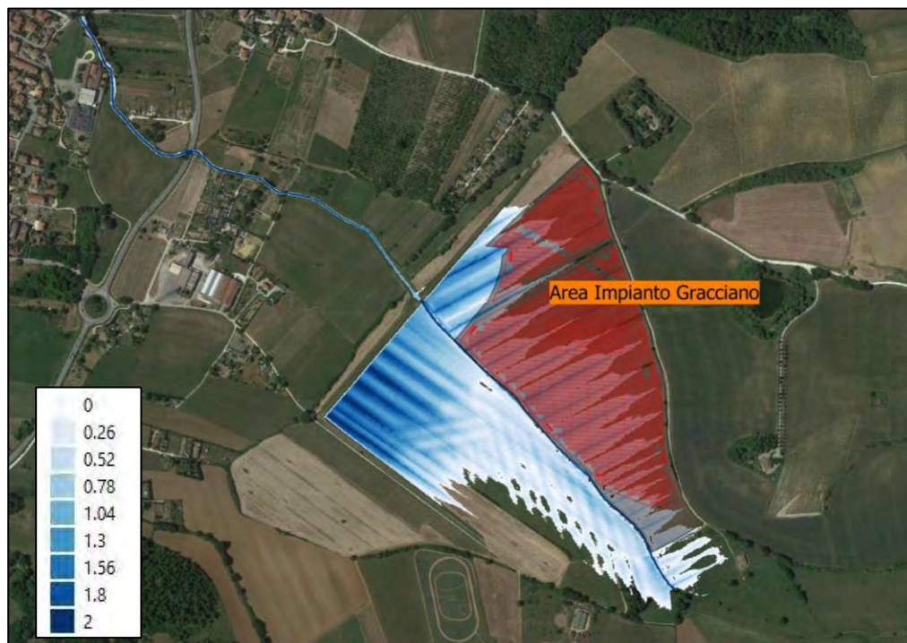
Figura 4.25: Torrente di Scarna, modello bidimensionale in moto vario (unsteady-flow): livelli idrici massimi (in metri) per portate di piena corrispondenti alla simulazione in condizione Tr = 30 anni
