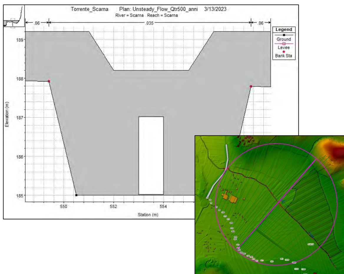
Figura 4.8: Torrente di Scarna: planimetria su DTM e dettaglio sezione verticale estesa inserimento opera in linea di regolazione dei livelli nella cassa di espansione
