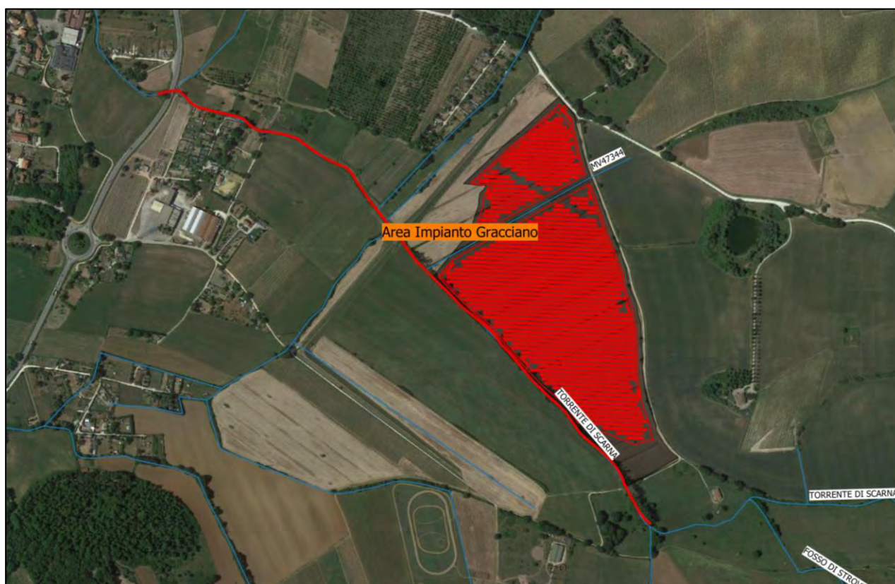
Figura 4.1: Scelta del tratto del Torrente di Scarna oggetto di modellazione (in rosso) in corrispondenza dell'area d'intervento. Sono indicati anche: in nero l'area dell'intervento in progetto e l'effettiva copertura dei pannelli fotovoltaici e delle opere accessorie d'impianto (campitura orizzontale in rosso)
