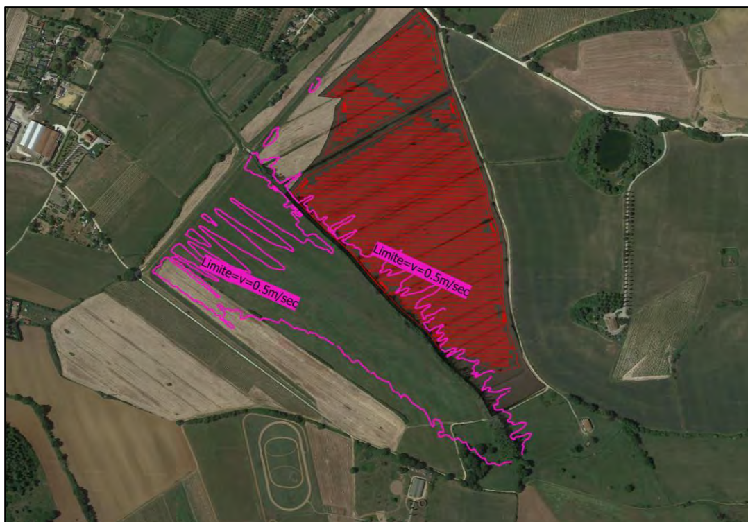
Figura 4.41: Torrente di Scarna, modello bidimensionale in moto vario (unsteady-flow): velocità massime (in metri/secondo) per portate di piena corrispondenti alla simulazione in condizione Tr = 200 anni e limite delle velocità pari a 0.50 m/sec in relazione all'area di installazione dei pannelli fotovoltaici e delle opere accessorie d'impianto
