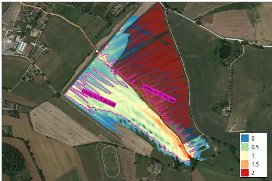
Figura 4.40: Torrente di Scarna, modello bidimensionale in moto vario (unsteady-flow): velocità massime (in metri/secondo) per portate di piena corrispondenti alla simulazione in condizione Tr = 200 anni e limite delle velocità pari a 0.50 m/sec in relazione all'area di installazione dei pannelli fotovoltaici e delle opere accessorie d'impianto
