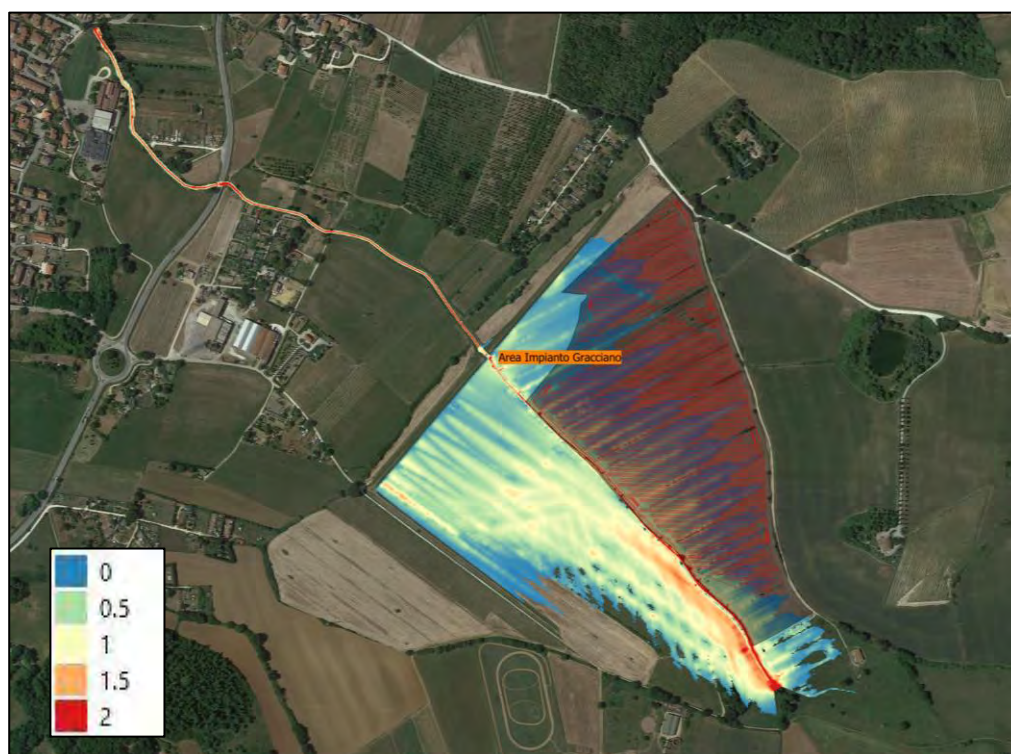
Figura 4.28: Torrente di Scarna, modello bidimensionale in moto vario (unsteady-flow): velocità massime (in metri al secondo) per portate di piena corrispondenti alla simulazione in condizione T_r = 200 anni
