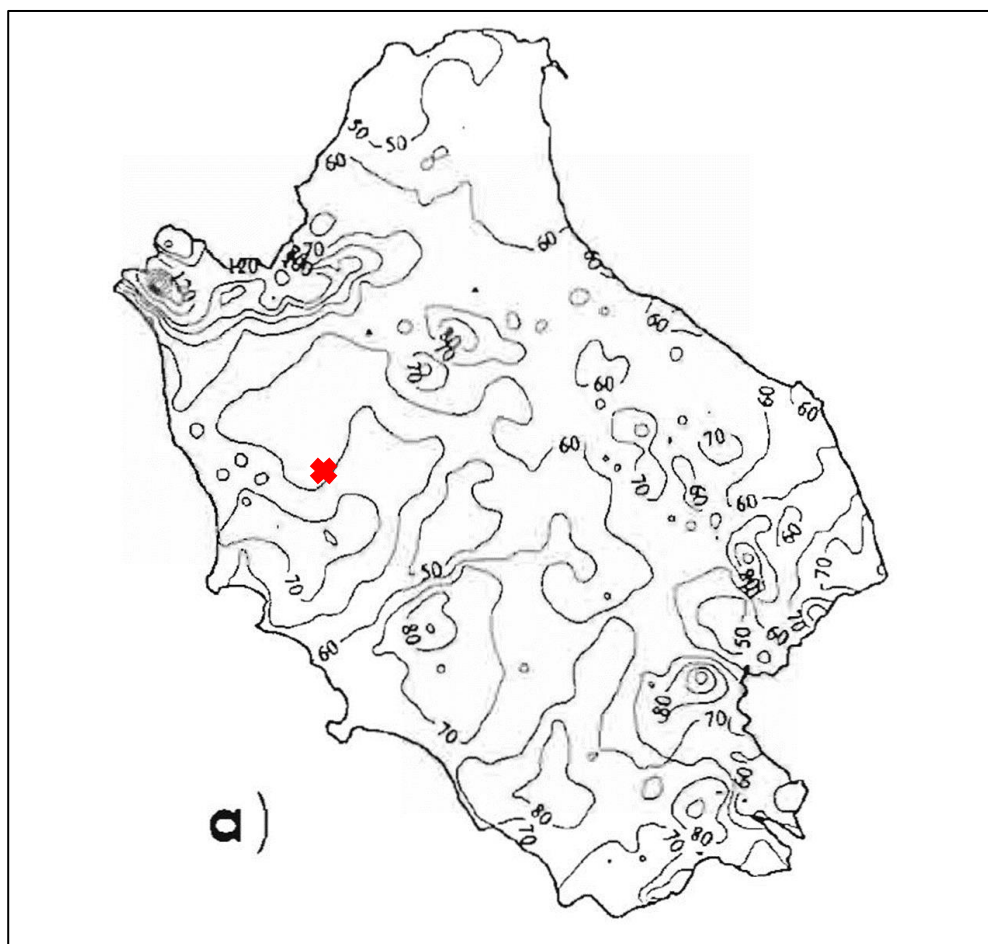
Figura 3.8: Terzo livello di regionalizzazione: distribuzione delle isolinee del parametro medio di pioggia massima giornaliera m_g e individuazione dell'area d'intervento nel Comune di Colle Val d'Elsa. (Fonte: Valutazione delle piogge intense nell'Italia Centrosettentrionale, Brath, Franchini, Galeati, 1998)
