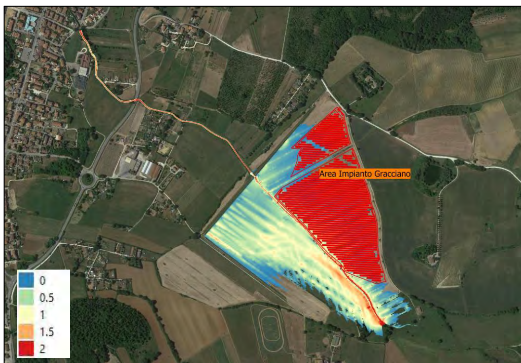
Figura 5.5: Torrente di Scarna, modello bidimensionale in moto vario (unsteady-flow): velocità massime (in metri/secondi) per portate di piena corrispondenti alla simulazione in condizione Tr = 200 anni in relazione all'ubicazione delle aree oggetto d'intervento (Q-GIS)
