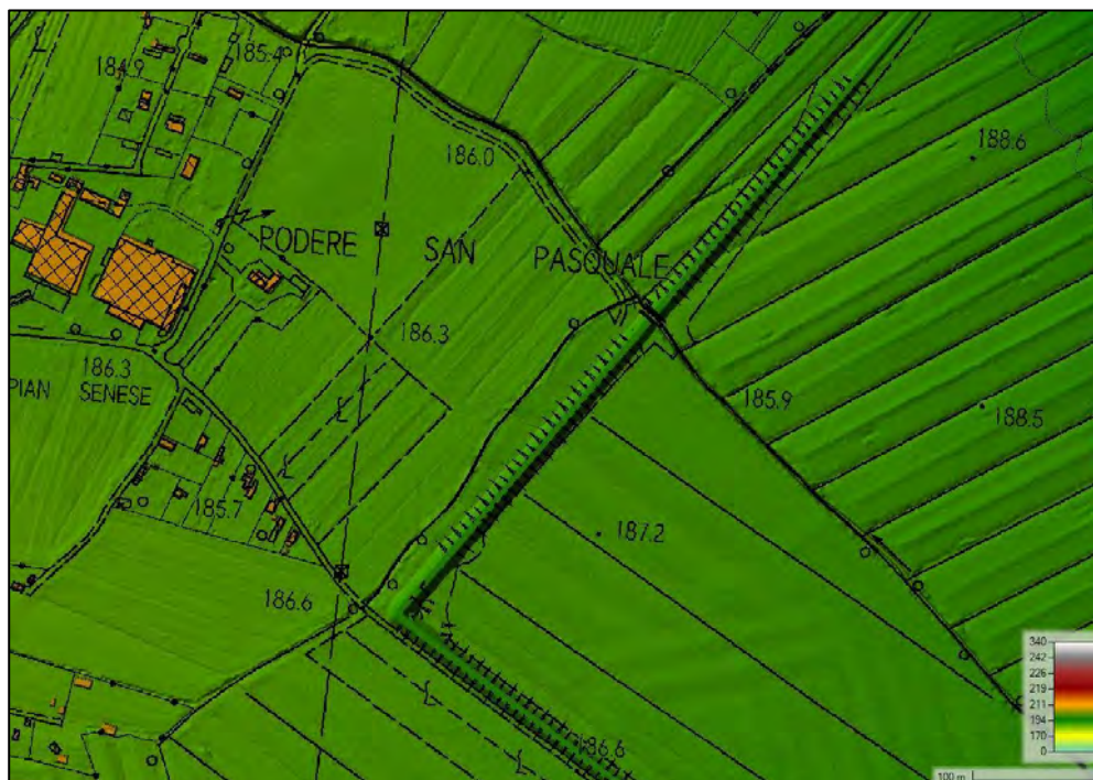
Figura 4.5: Importazione DTM da rilievo LIDAR e creazione del Terrain nell'ambiente di modellazione del software HEC-RAS. Dettaglio sovrapposizione con CTR e ricondizionamenti locali per l'inserimento delle sezioni tipologiche del Torrente di Scarna, del rilevato arginale della cassa e dell'abitato nell'area
