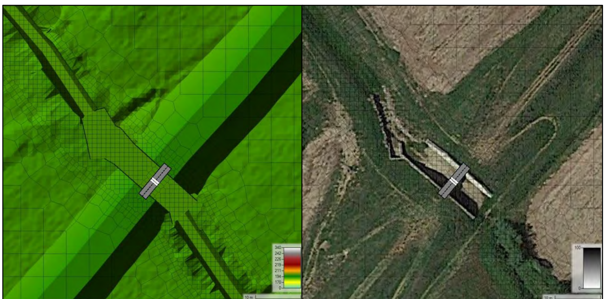
Figura 4.13: Modello bidimensionale, Torrente di Scarna: schema planimetrico DTM (a sinistra) e Google (a destra) opera di collegamento (SA/2D Connection) interna al dominio di calcolo, a schematizzare l'opera in linea di regolazione delle portate della cassa di laminazione
