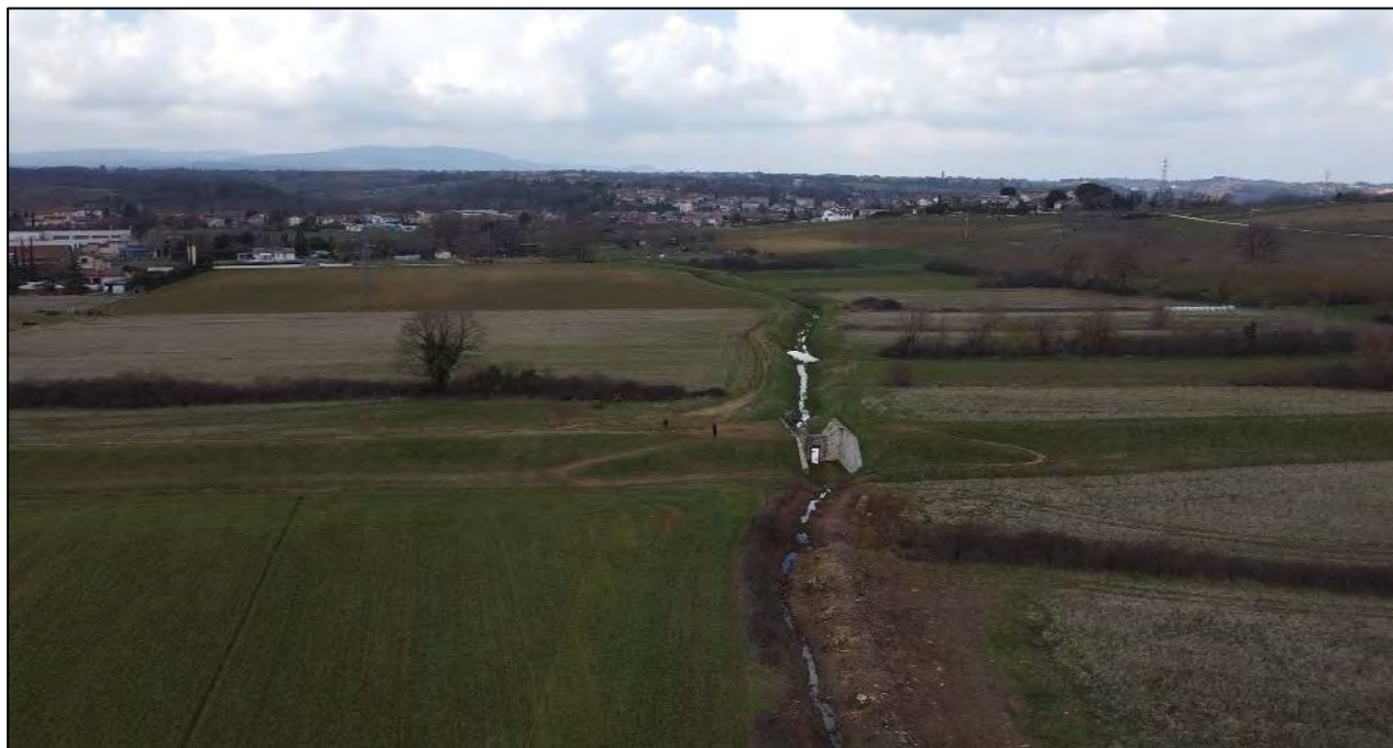
Figura 2.10: Sopralluogo nell'area di ubicazione dell'impianto, posizione 1: sezione defluente del Torrente di Scarna in prossimità dell'opera di regolazione in linea delle portate, vista da monte verso valle, scatto aereo da drone. Si intuisce l'importante estensione dell'area adibita a cassa di espansione delle piene e si nota il fosso affluente in destra idraulica denominato MV47344
