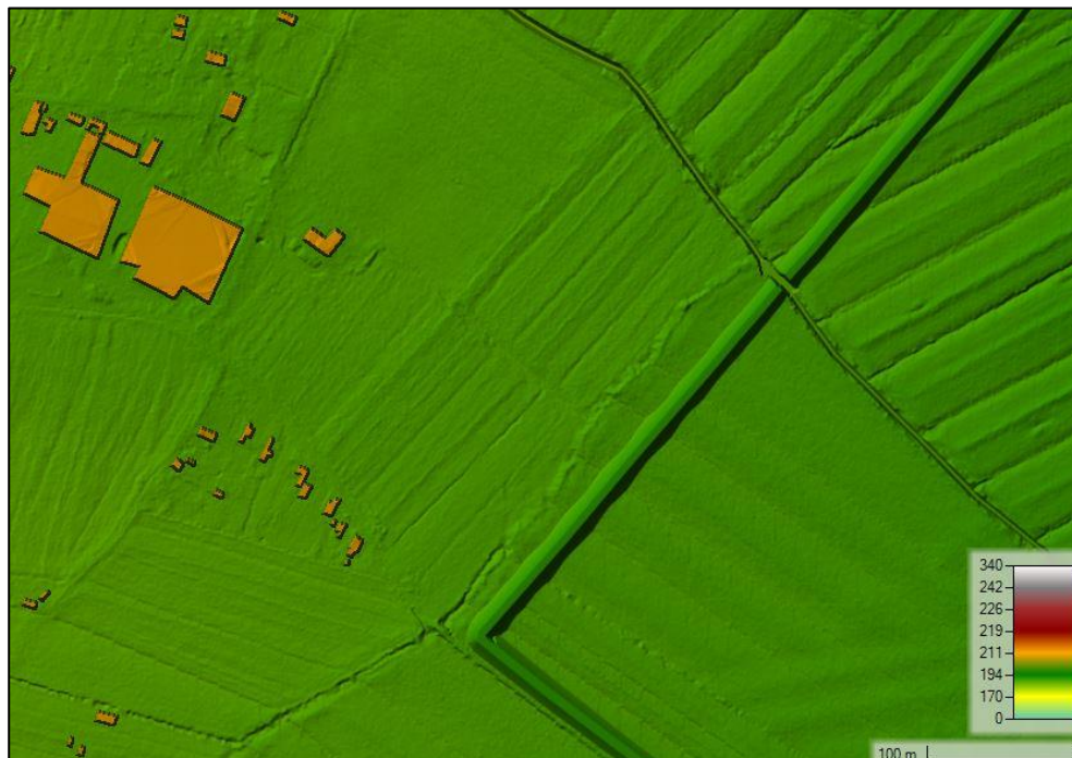
Figura 4.4: Importazione DTM da rilievo LIDAR e creazione del Terrain nell'ambiente di modellazione del software HEC-RAS. Dettaglio ricondizionamenti locali per l'inserimento delle sezioni tipologiche del Torrente di Scarna, del rilevato arginale della cassa e dell'abitato nell'area
