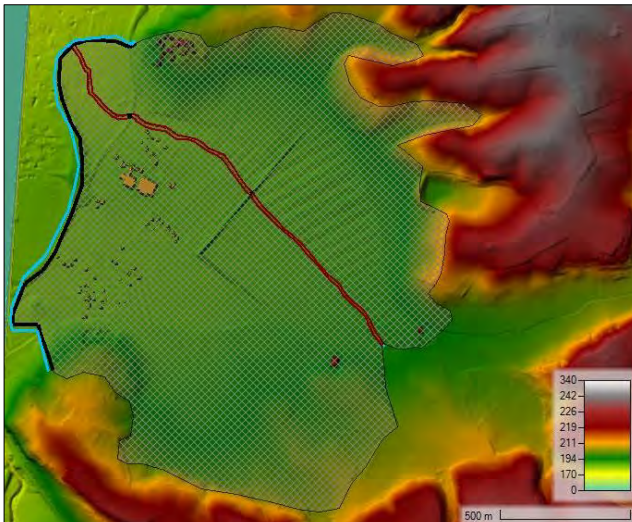
Figura 4.10: Torrente di Scarna: definizione degli elementi geometrici della modellazione bidimensionale su DTM da rilievo LIDAR integrato con rilievi in campo nell'area dell'intervento. Retino quadrato: dominio di modellazione bidimensionale mesh 5x5 mt (2D Flow Area). Poligoni rossi: aree di infiltrazione dominio di calcolo con mesh di dimensione 1x1 mt. Segmenti azzurri: posizione condizioni al contorno di monte e di valle (SA/2D BC Line)
