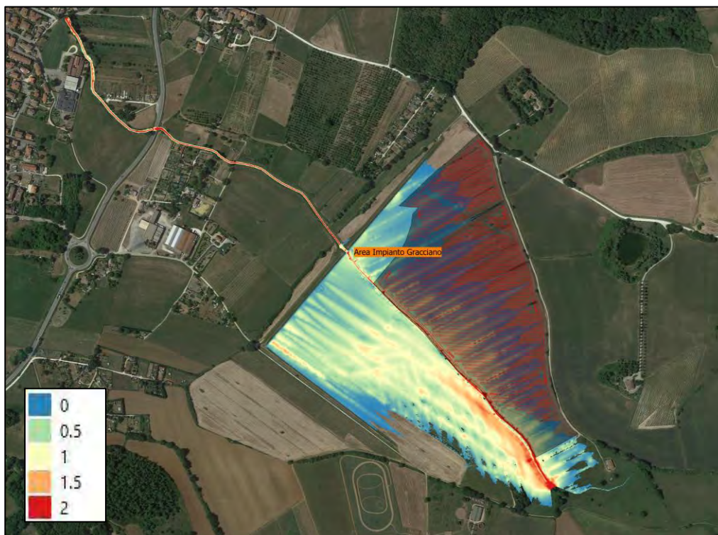
Figura 4.30: Torrente di Scarna, modello bidimensionale in moto vario (unsteady-flow): velocità massime (in metri al secondo) per portate di piena corrispondenti alla simulazione in condizione Tr = 200 anni
