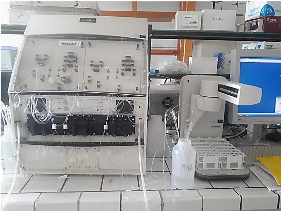
QuAAtro è un moderno analizzatore a chimica umida che è utilizzato per automatizzare reazioni chimiche complesse.
