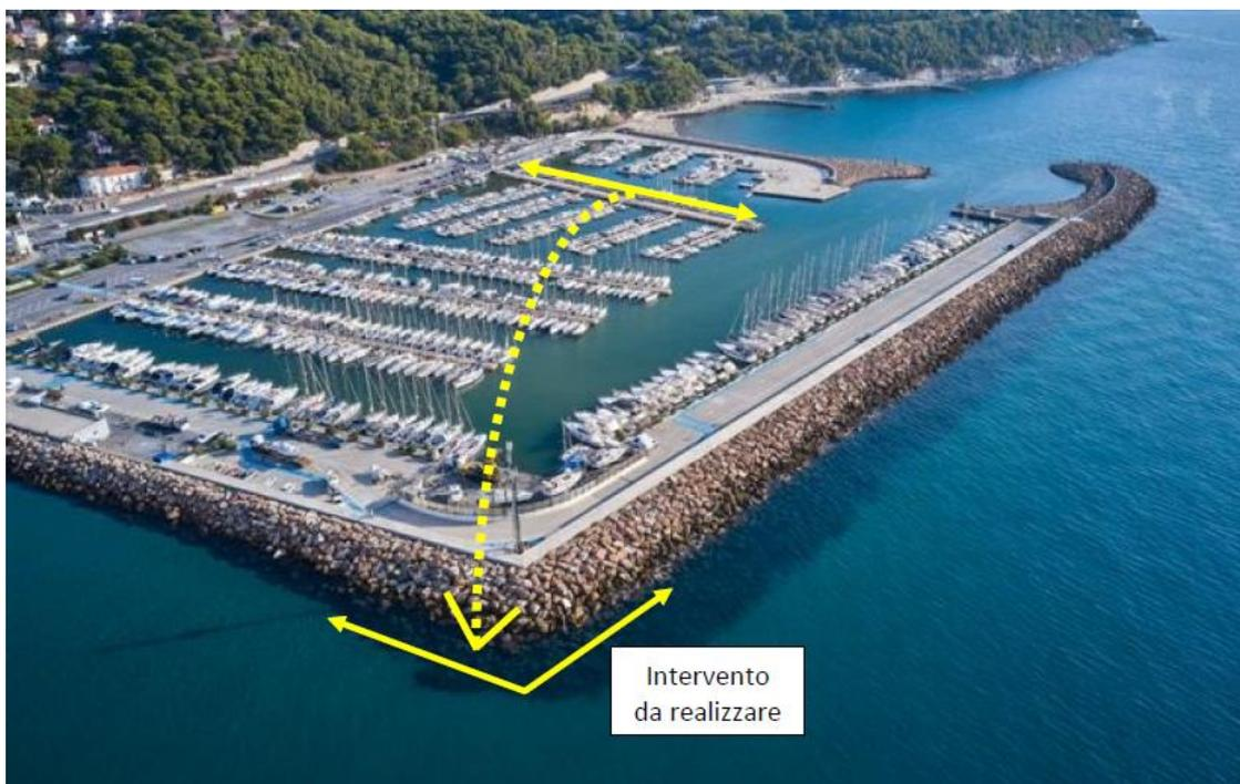
Figura 1 - Spostamento di massi dalla ex diga di sottoflutto alla berma del gomito della diga di sopraflutto.
