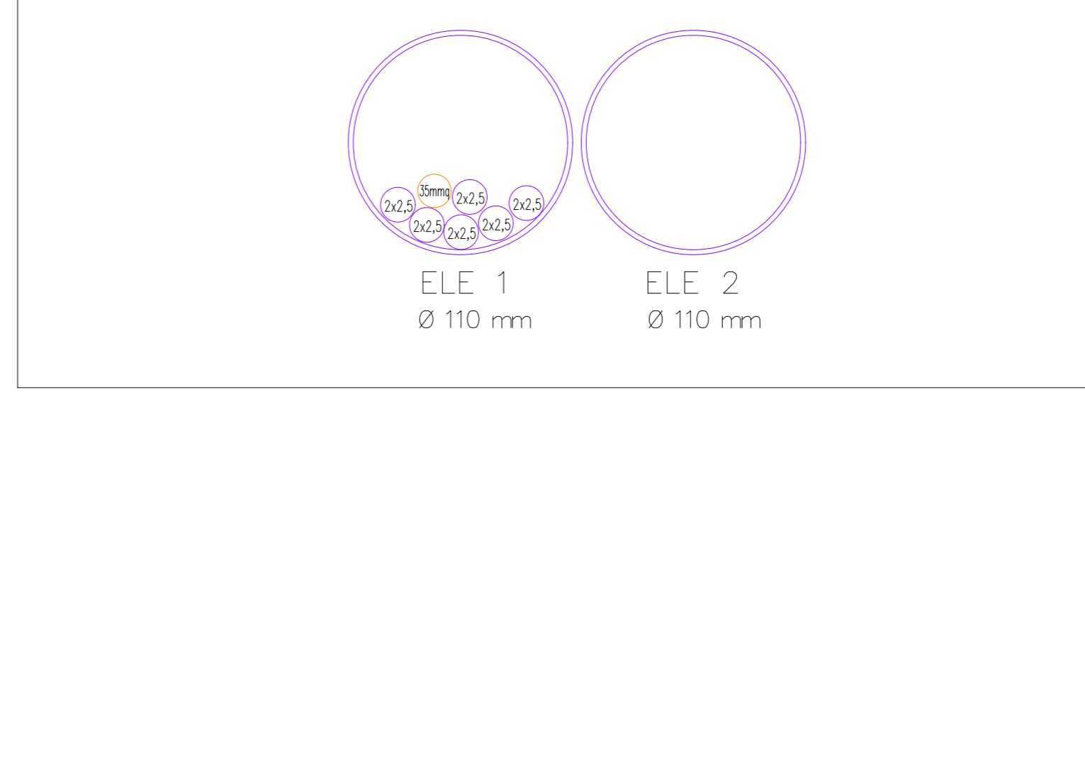
VERIFICA STIPAMENTO CAVI QCV7P - Ad uso ciclopedonale - pk 95+806
