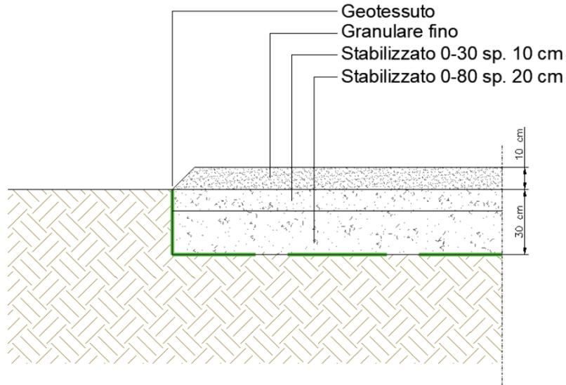
Figura 2: Sezione tipo viabilità interna all'impianto e piazzali
