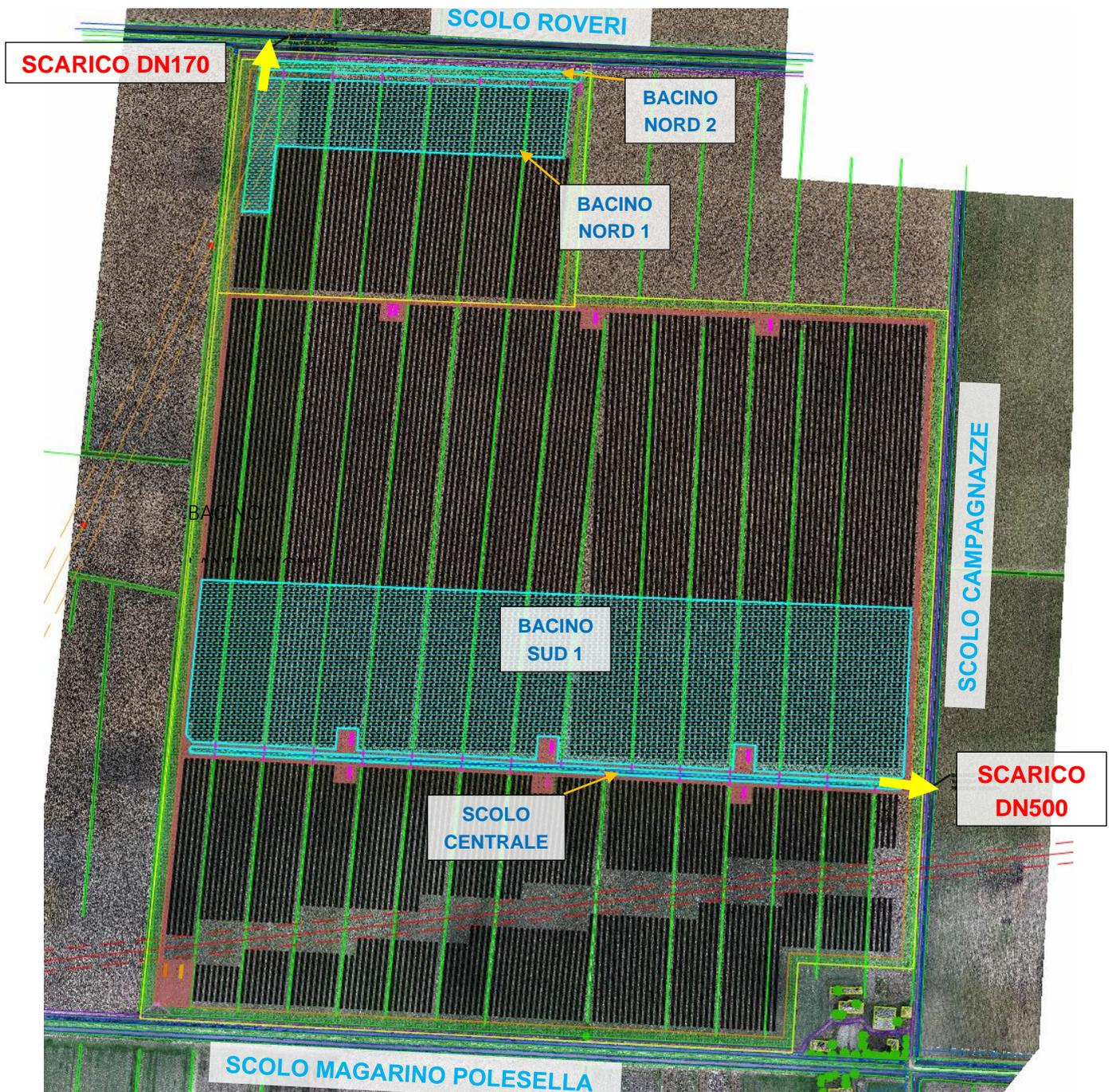
Figura 7.2 — Schema impianto drenaggio acque meteoriche – Impianto OVEST
