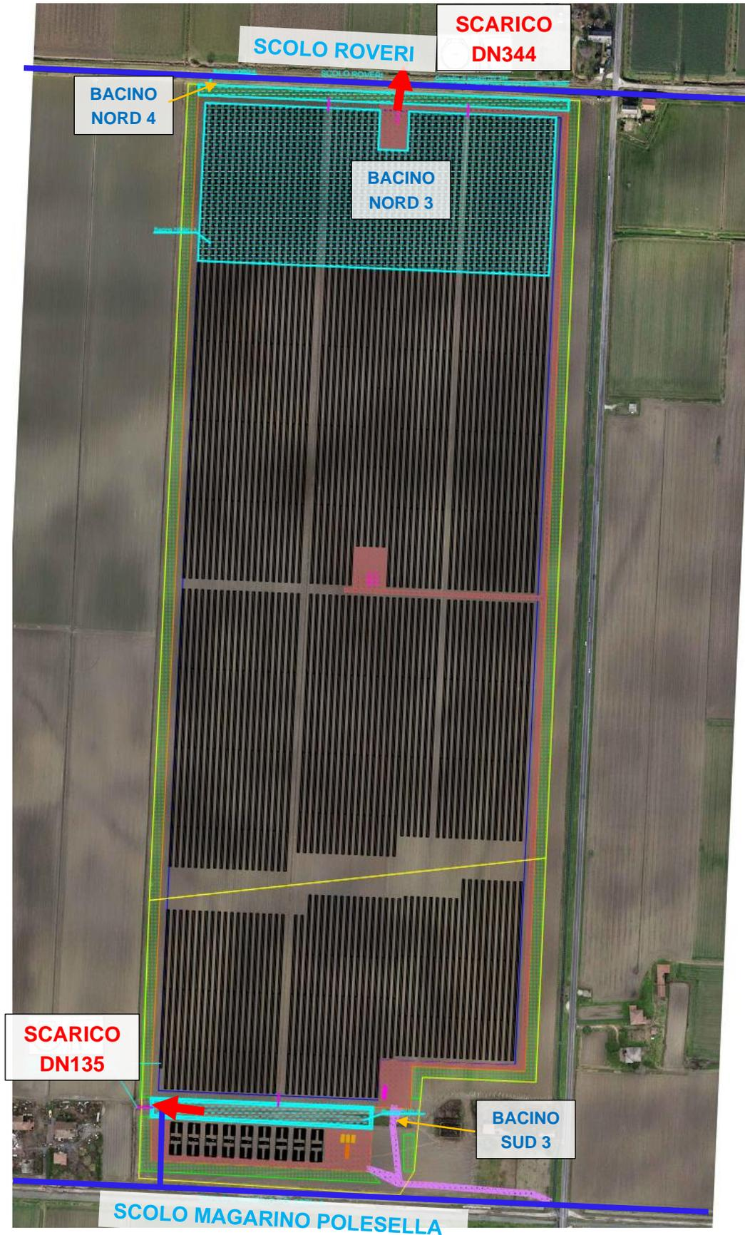
Figura 7.3 - Schema impianto drenaggio acque meteoriche – Impianto OVEST
