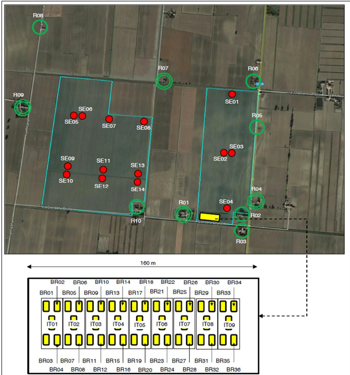
Figura 6 - Foto aerea dell'area di influenza dell'Impianto agrivoltaico (SE= skid di trasformazione FV) e zoom sulla centrale di accumulo
