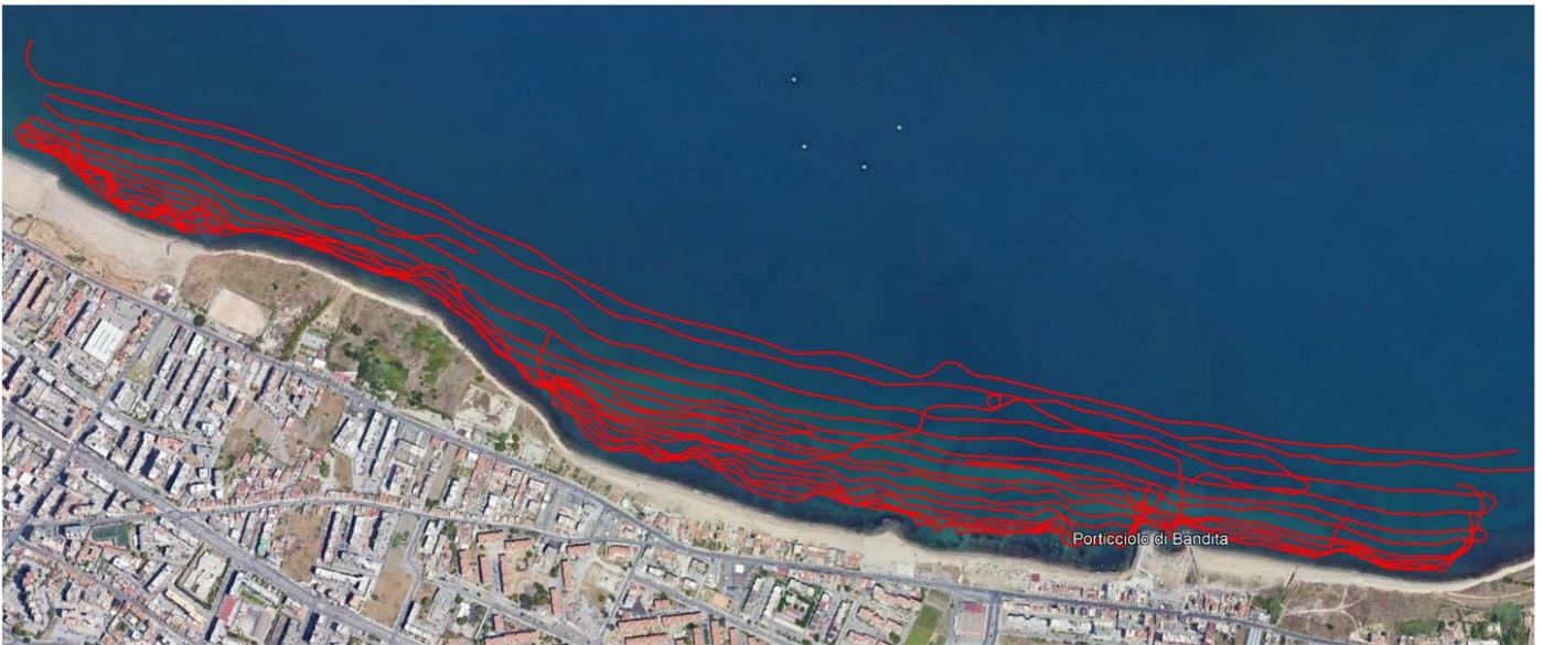
Figura 54 - Tracce delle rotte navigate con il Multibeam
