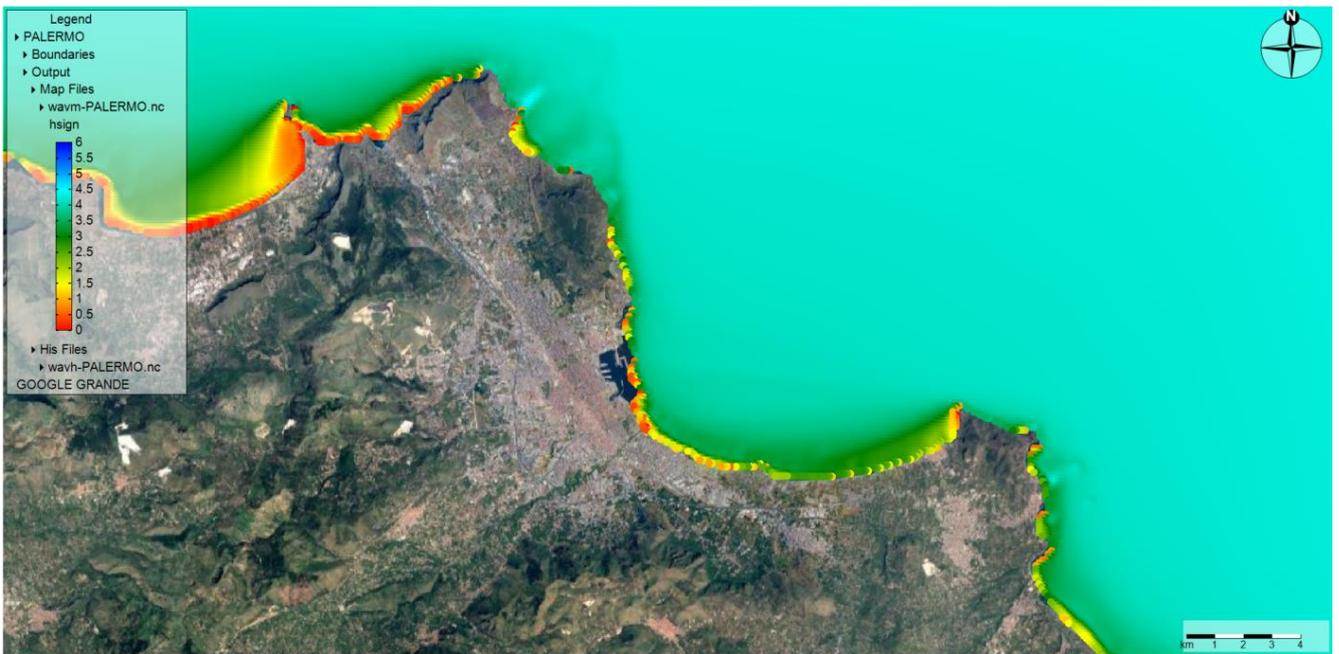
Figura 25 - Propagazione moto ondoso -  $T_r = 100$  anni - direzione di provenienza  $45^\circ$  N
