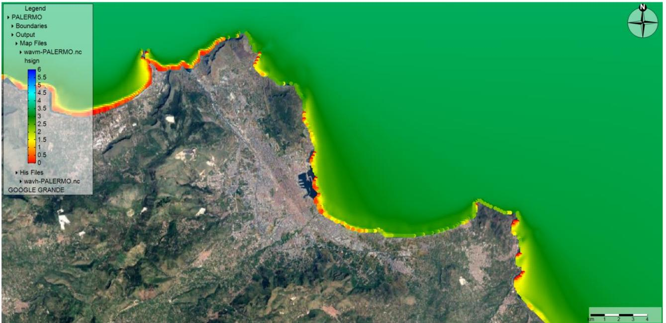
Figura 18 – Propagazione moto ondoso -  $T_r = 10$  anni - direzione di provenienza  $0^\circ$  N
