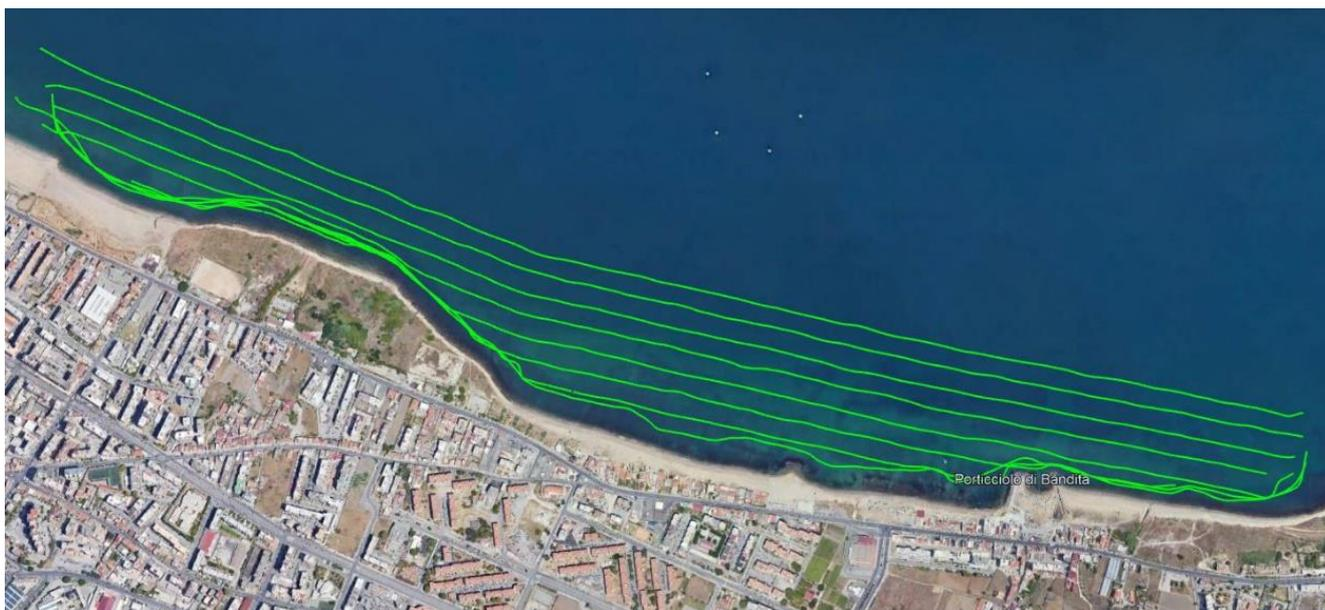
Figura 58 - Tracce delle rotte navigate con il Side Scan Sonar
