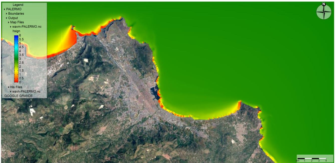
Figura 20 - Propagazione moto ondoso -  $T_r = 10$  anni - direzione di provenienza  $45^\circ N$
