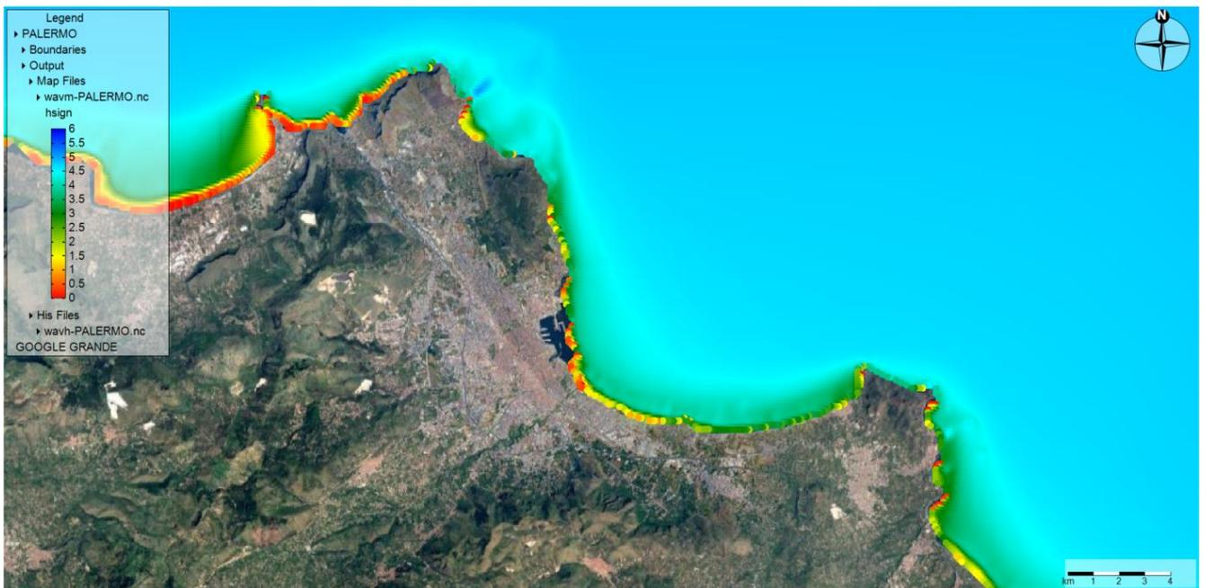
Figura 24 - Propagazione moto ondoso -  $T_r = 100$  anni - direzione di provenienza  $22.5^\circ N$
