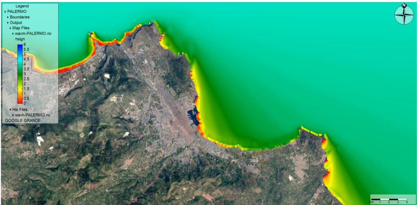
Figura 22 - Propagazione moto ondoso -  $T_r = 10$  anni - direzione di provenienza  $337.5^\circ N$
