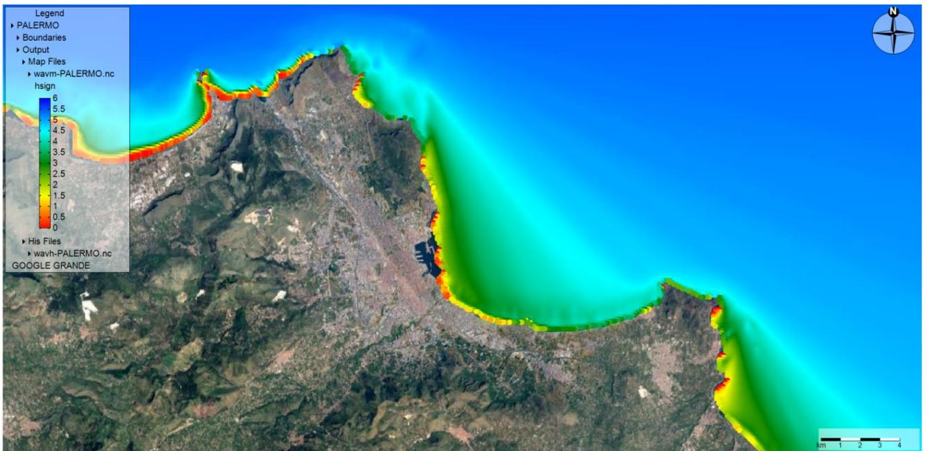
Figura 27 - Propagazione moto ondoso -  $T_r = 100$  anni - direzione di provenienza  $337.5^\circ N$
