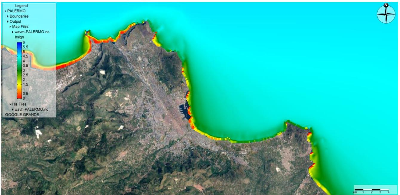
Figura 23 - Propagazione moto ondoso -  $T_r = 100$  anni - direzione di provenienza  $0^\circ$  N
