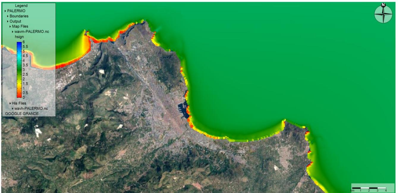
Figura 19 Propagazione moto ondoso -  $T_r = 10$  anni - direzione di provenienza  $22.5^\circ N$
