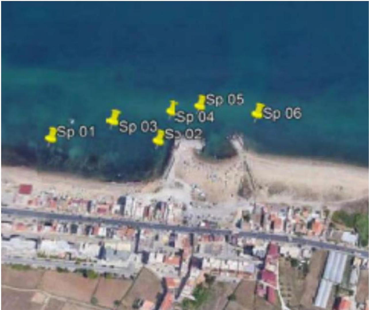
Fig. 9 - Ortofoto con indicazione dei sondaggi effettuati.
