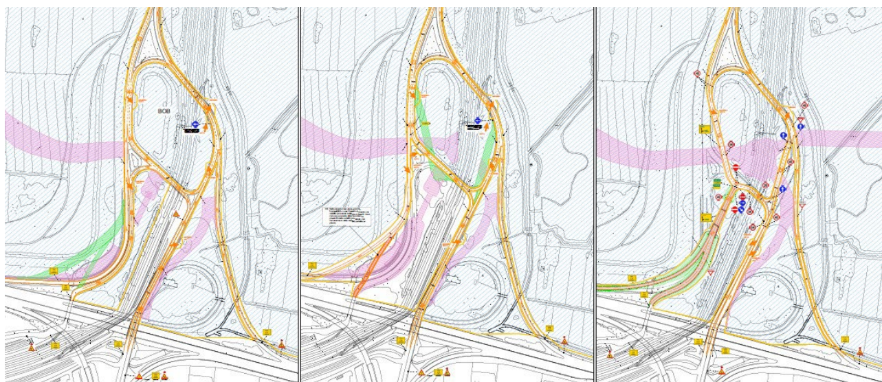
Figura 27. Fasi di cantierizzazione nodo viario B
