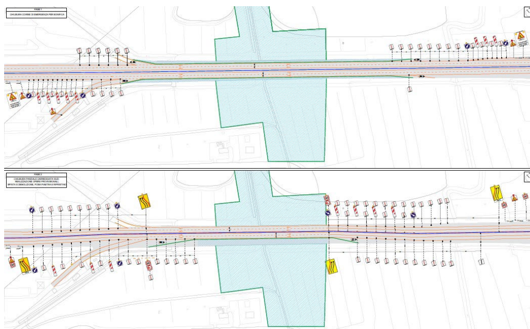
Figura 31. Attraversamento idraulico prima e seconda fase
