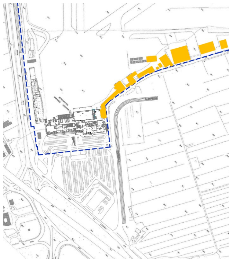
Figura 18 - Schema demolizioni per nuova costruzione
