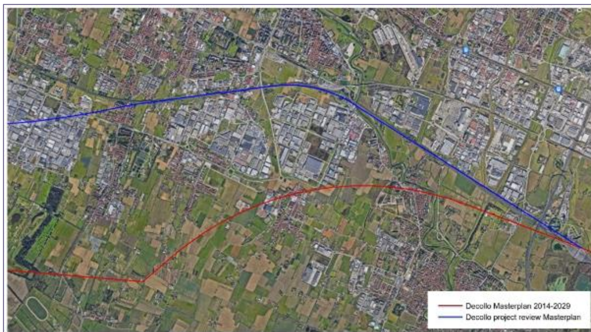
Figura 56 - Confronto tra traiettorie di decollo previste nel Masterplan 2014-2029 (pista 12-30) e nel project review del Masterplan (pista 11-29)
