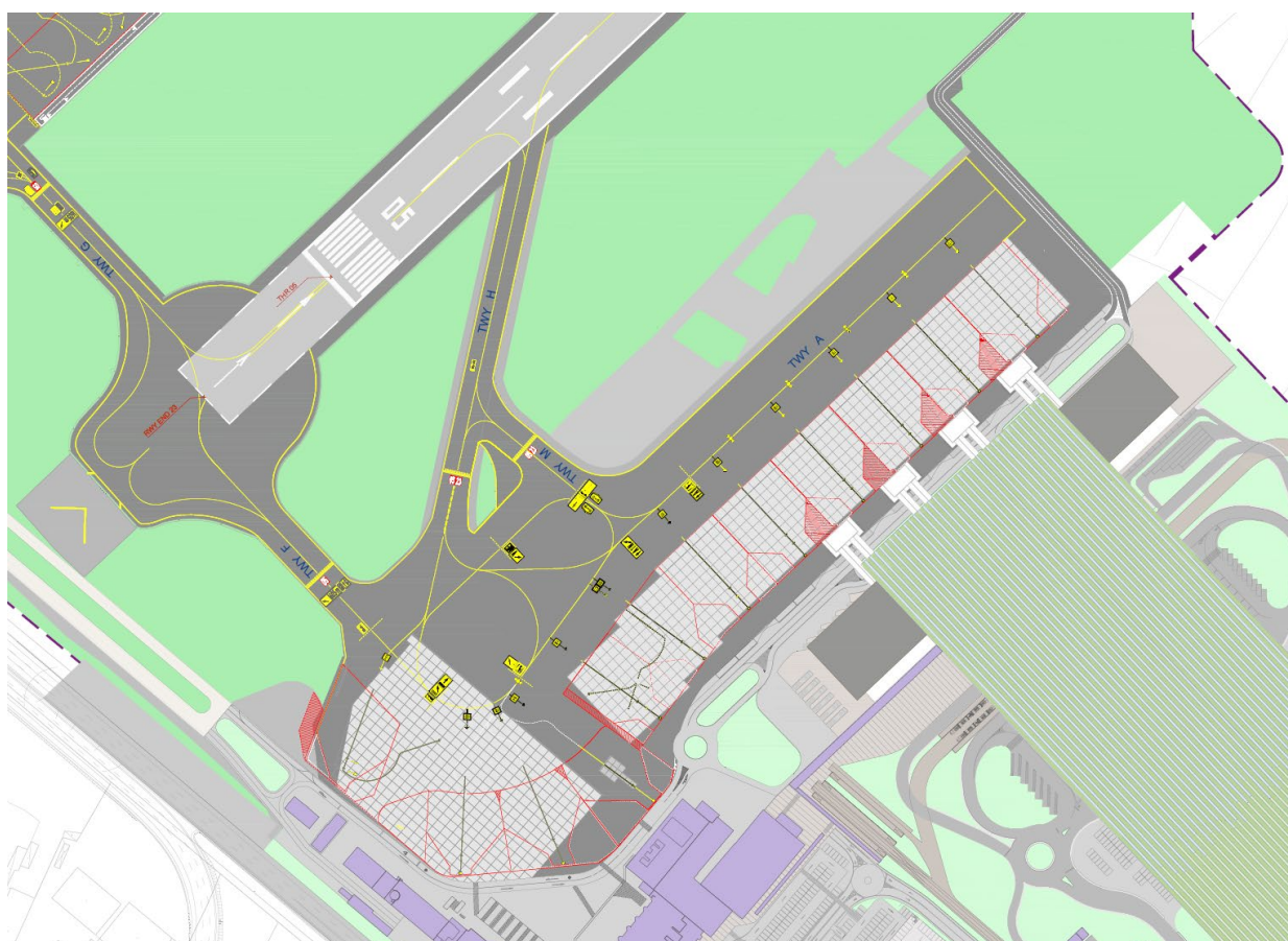
Figura 7 Fase A – dettaglio Apron 100 durante la fase di costruzione della nuova pista di volo 11-29
