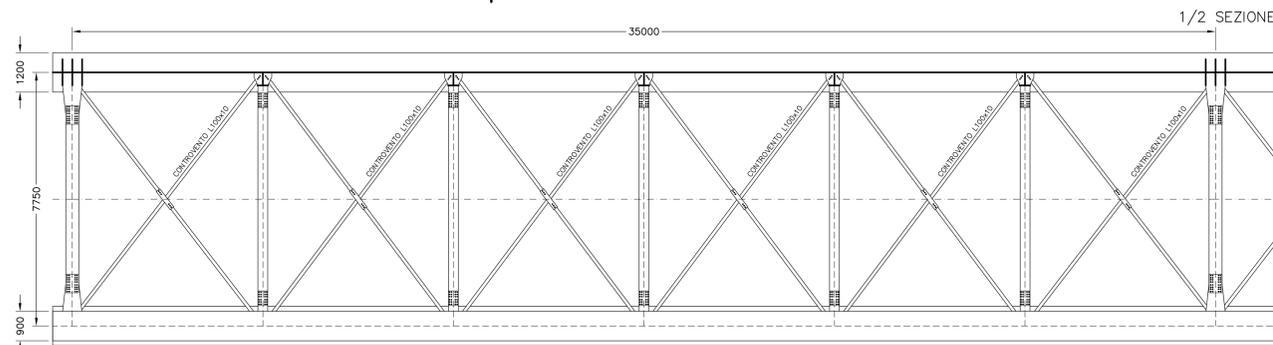
SEZIONE LONGITUDINALE CAMPATE 1-7 CARREGGIATA DX tipo L=35m SCALA 1:100
