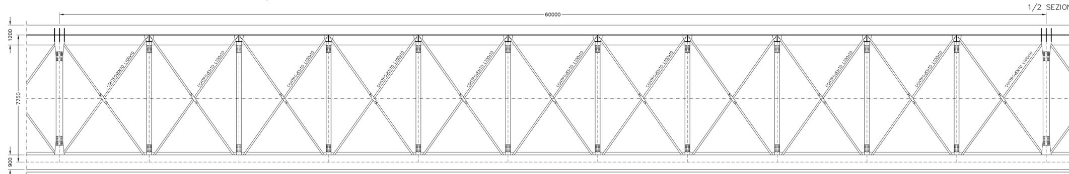
SEZIONE LONGITUDINALE CAMPATE 3-4-5 CARREGGIATA DX tipo L=60m SCALA 1:100
