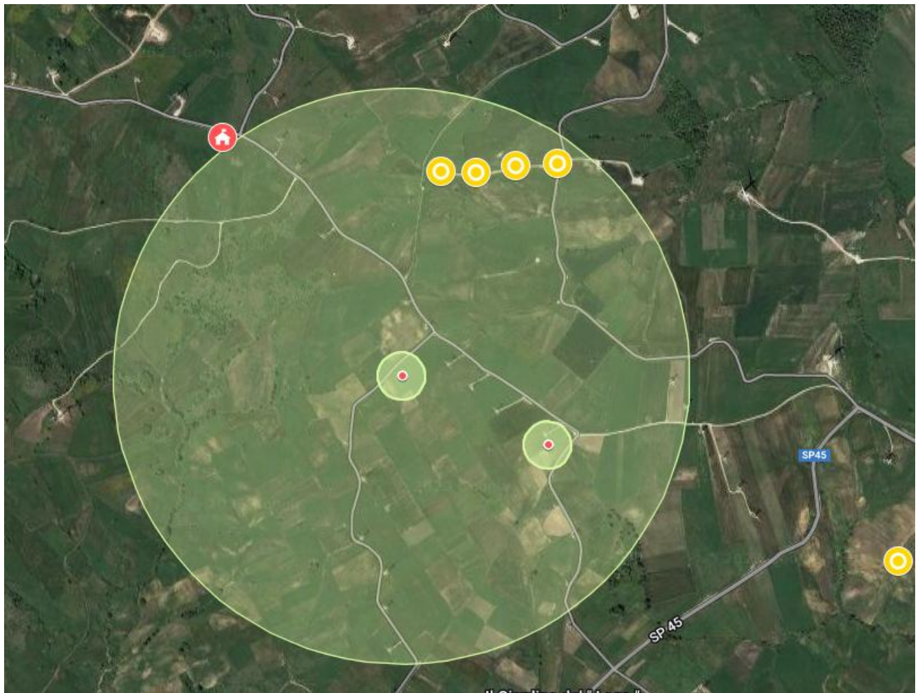
Aerogeneratore SGM01 – Distacco frammento a 10 metri dalla punta dell'organo rotante con ricettori sensibili entro la distanza di lancio di m. 837.05
