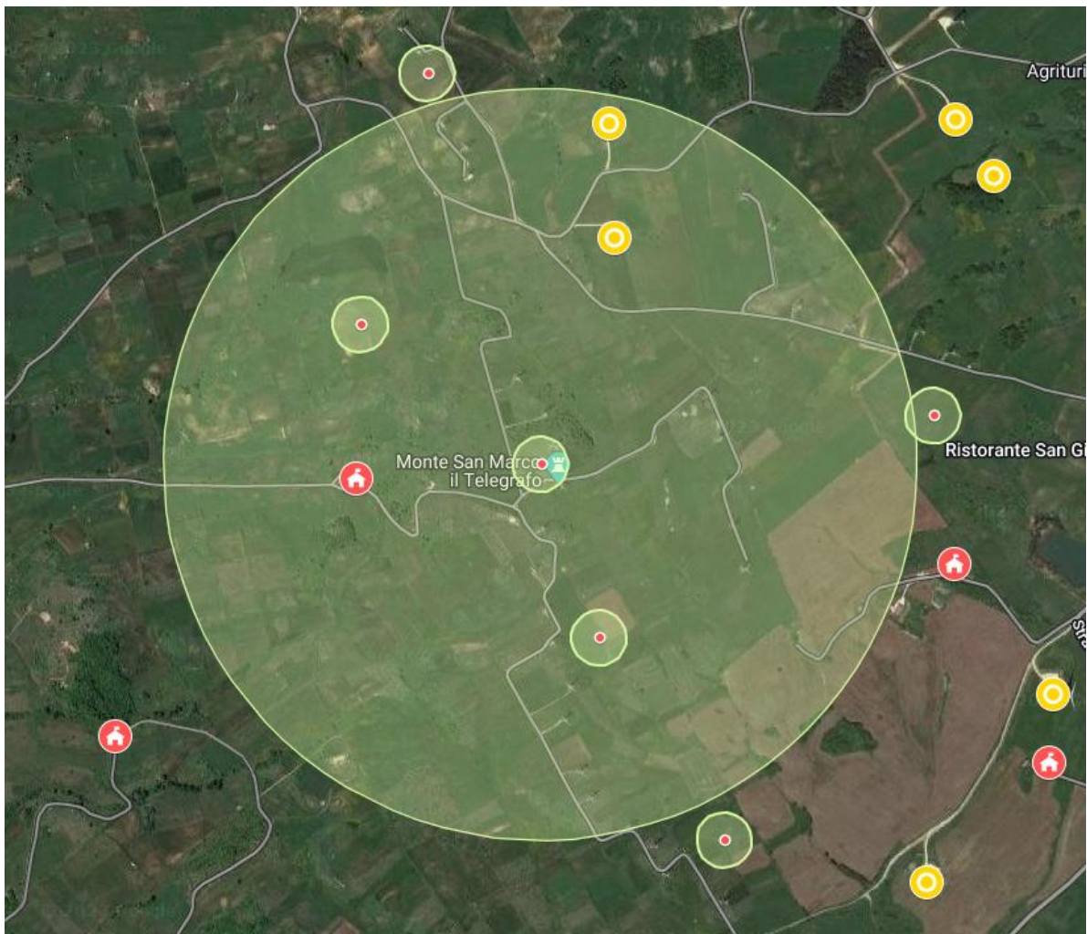
Aerogeneratore SMC02 – Distacco frammento a 10 metri dalla punta dell'organo rotante con ricettori sensibili entro la distanza di lancio di m. 948.23
