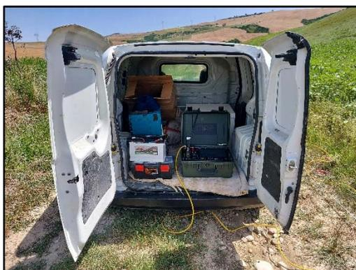
**Fotografia 3**-Georesistivimetro MAE modello X612 EM48
