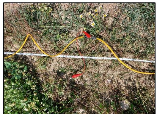
**Fotografia 4**-Cavo multipolare e collegamento picchetti
