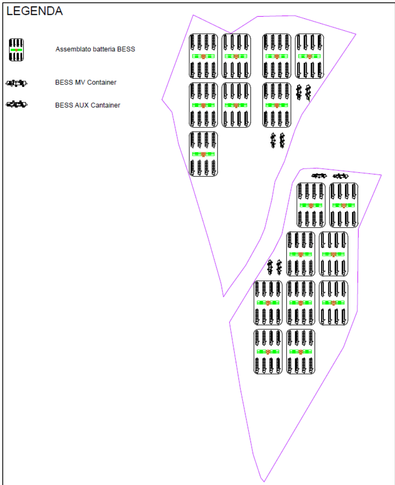
Figura 13.7.1: Configurazione BESS di potenza 64,8 MWp
