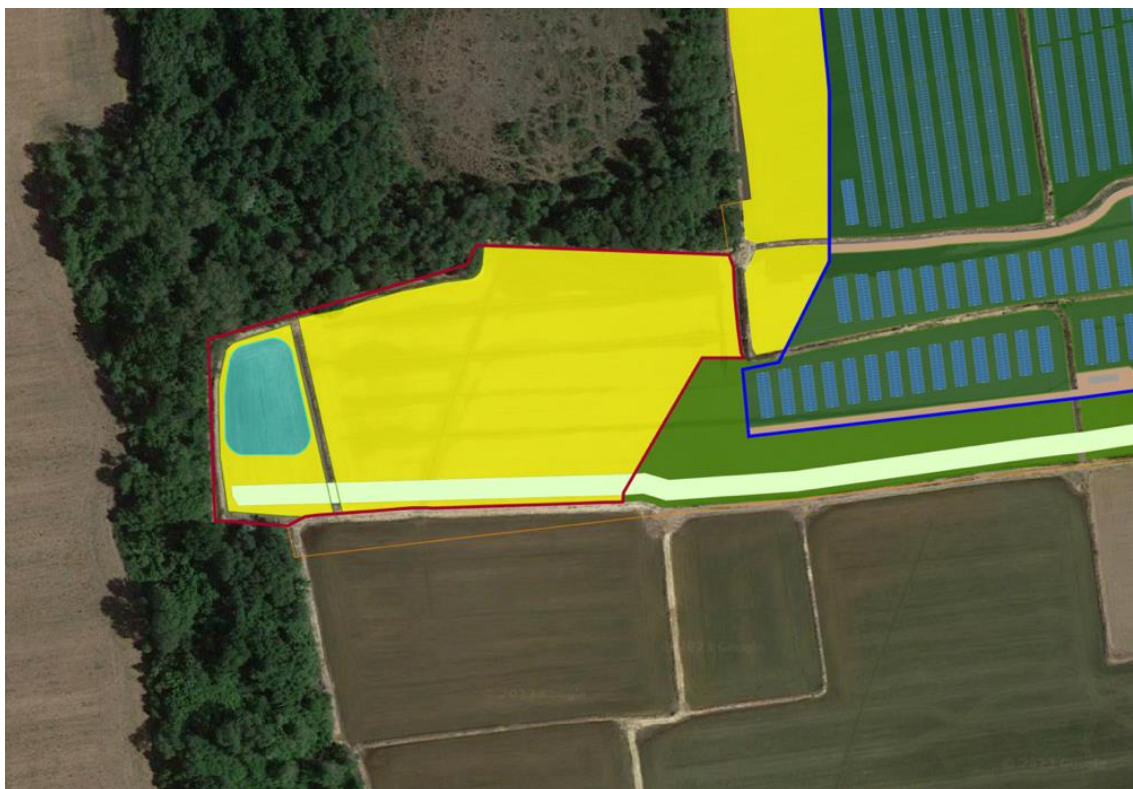
Figura 30. Particolare del progetto. Contornata in rosso l'area ricadente all'interno della ZSC, evidenziata in giallo l'area a prato polifita, in azzurro la zona umida e in verde pallido la fascia mitigativa.
