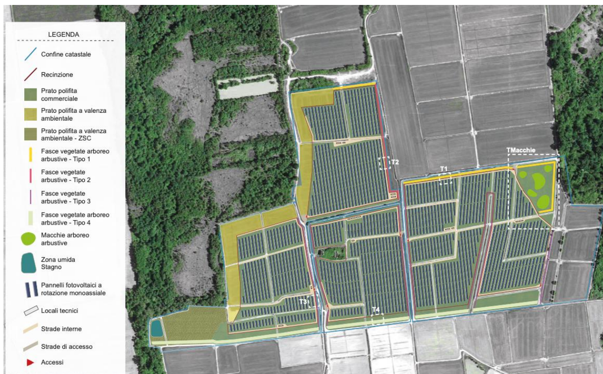
Figura 19 Planimetria individuazione sesti opere di mitigazione e compensazione ambientale. Immagine estratta dall'elaborato M_7.1_MAS_OMA_1_Opere di mitigazione.
