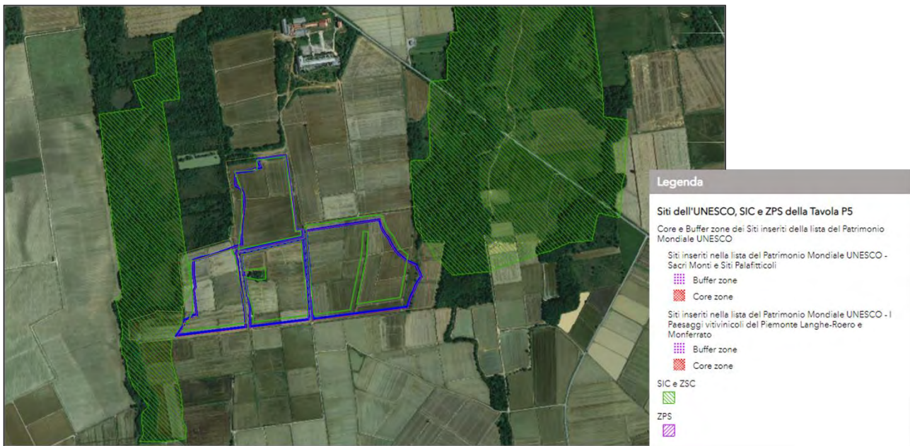
Figura 12 - Stralcio Tavola P5 “Rete di connessione Paesaggistica” del P.P.R. (fuori scala); in blu la recinzione dei sottocampi costituenti l’impianto fotovoltaico nel progetto presentato in prima istanza e la linea verde l’area recintata relativa alla riprogettazione.
