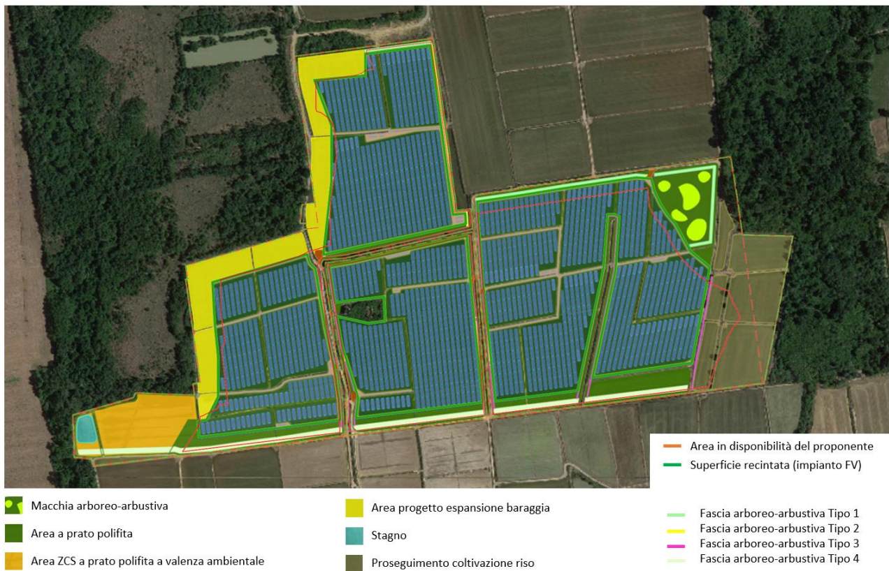
Figura 1. Nuovo layout di progetto (componente fotovoltaica e opere di mitigazione e compensazione) in cui si evidenzia la riduzione dell'ingombro previsto per la componente fotovoltaica (il perimetro in tratto rosso continuo si riferisce all'area recintata prevista in prima istanza, il perimetro verde la nuova area recintata; le linee tratteggiate si riferiscono alle aree catastali: tratteggiato rosso vecchia area catastale; tratteggiato verde nuova area catastale)).
