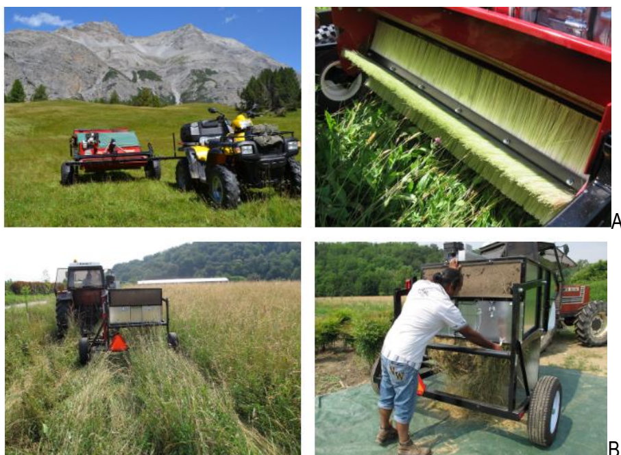
Figura 10. Macchine spazzolatrici idonee per la raccolta del fiorume 15 .
