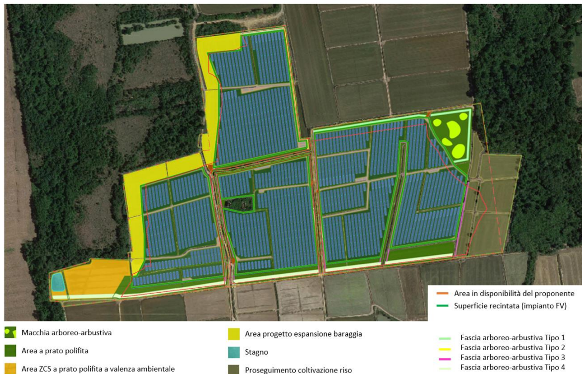
Figura 7. Schematizzazione delle opere di inserimento ambientale previste nel progetto, l'opera di ripristino dell'habitat 4030 verrà attuata progressivamente sull'area rappresentata evidenziata in giallo, a seguire (lato ovest) la superficie compresa nella ZSC che sarà invece dedicata all'attivazione di una prateria (cod. 6510).
