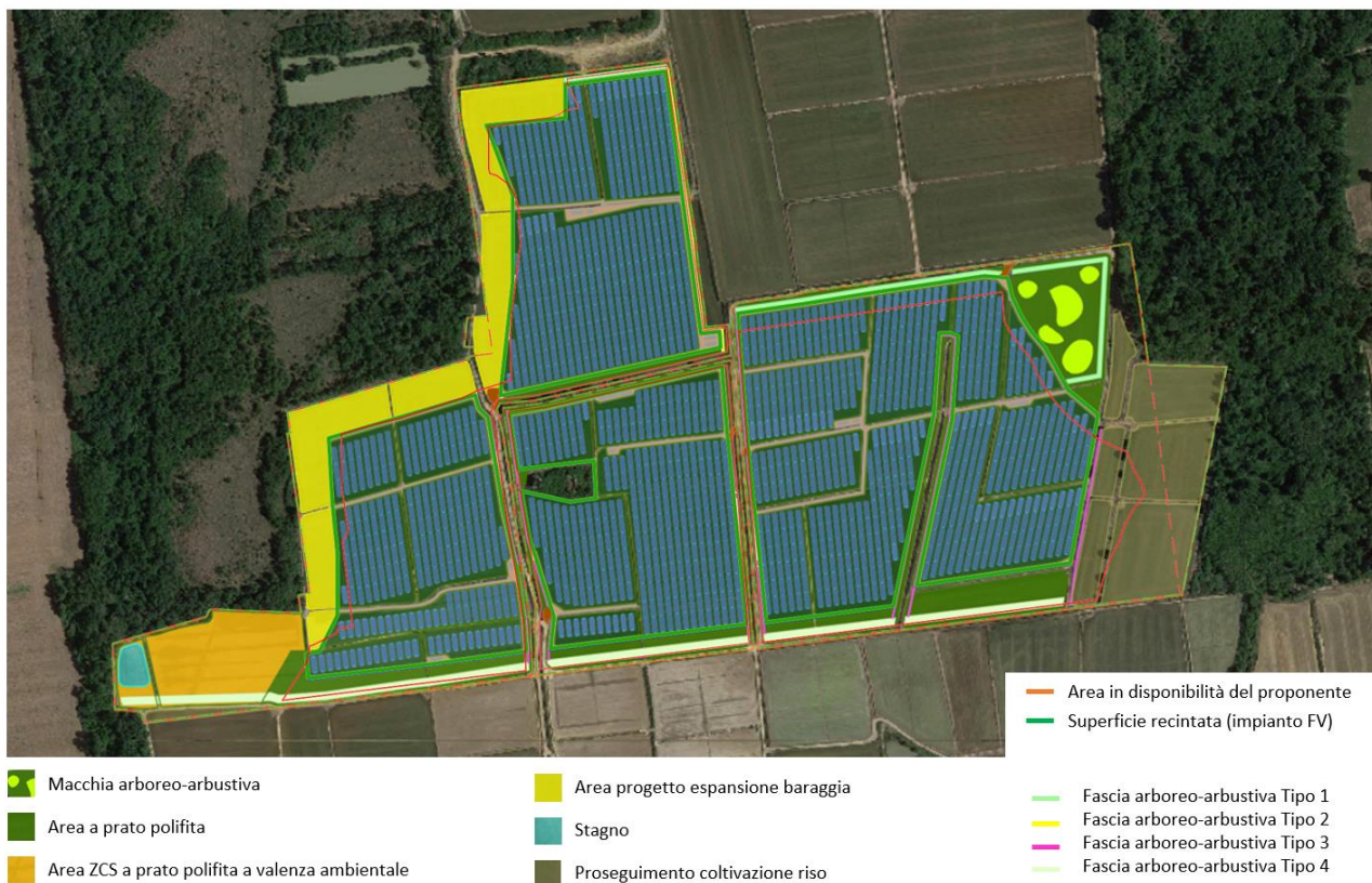
Figura 1: Nuovo layout di progetto (componente fotovoltaica e opere di mitigazione e compensazione) in cui si evidenzia la riduzione dell'ingombro previsto per la componente fotovoltaica (il perimetro in tratto rosso continuo si riferisce all'area recintata prevista in prima istanza, il perimetro verde la nuova aerea recintata; le linee tratteggiate si riferiscono alle aree catastali: tratteggiato rosso vecchia area catastale; tratteggiato verde nuova area catastale)).
