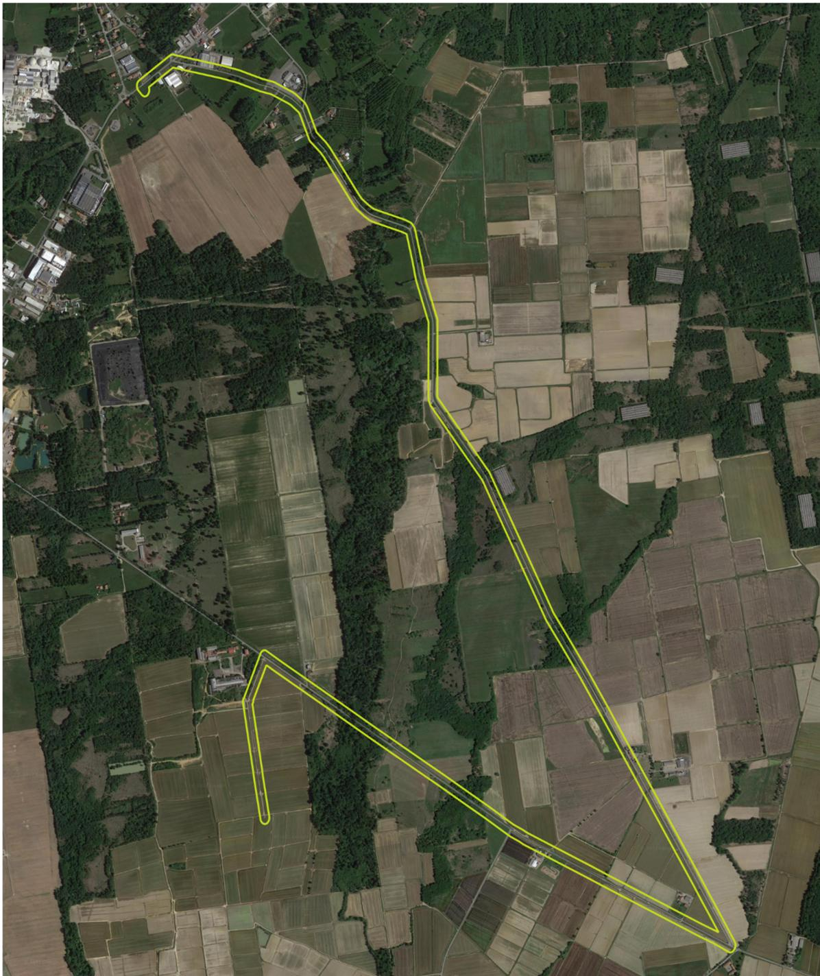
Tracciato linea AT interrata di collegamento dell'impianto alla cabina primaria; in giallo è riportata la zona buffer di 30 m
