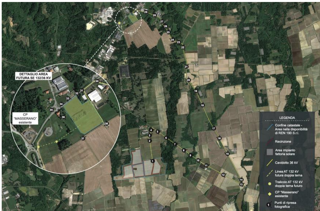
Figura 50. Inquadramento del cavidotto e dettaglio dell'area interessata dalla costruzione della futura SE 132/36 KV.
