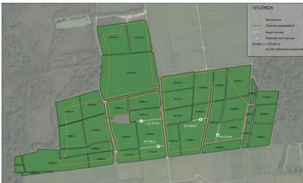
Figura 67. Rappresentazione del nuovo layout di impianto nel quale si evidenziano gli arginelli che verranno rimossi allo scopo di unire le camere di risaia.
