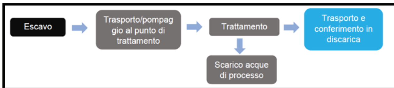
Figura 6: Schema delle fasi del ciclo di dragaggio.
