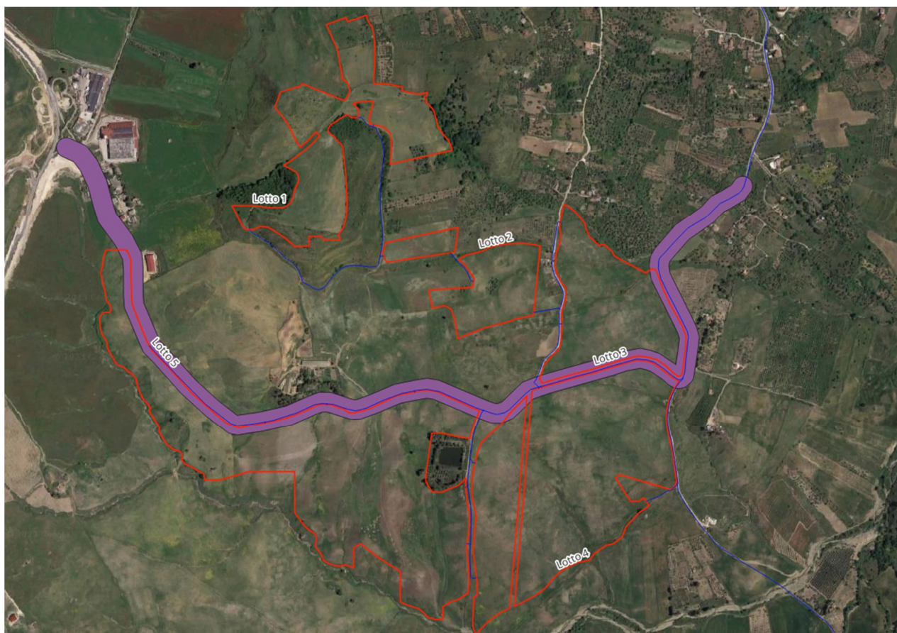
Figura 13 – Dettaglio dell'area di impianto (in rosso) e delle strade di tipo C accatastate ed il relativo buffer di 30 m (in viola).
