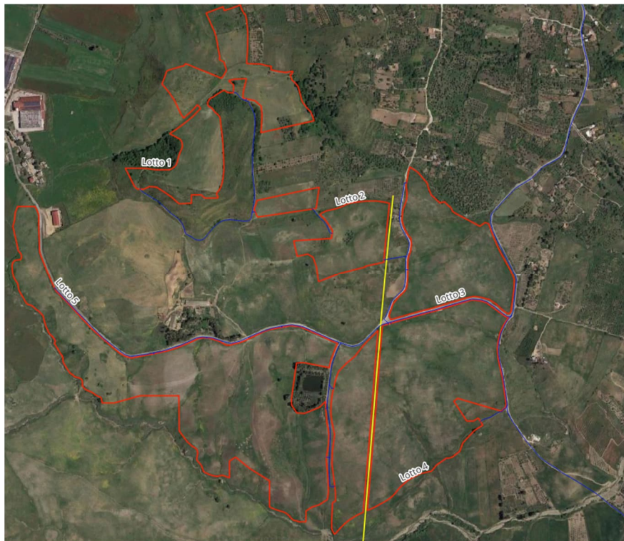
Figura 22 -Linee elettriche presenti nell'area di impianto. In giallo (linee MT) in rosso (area di impianto).
