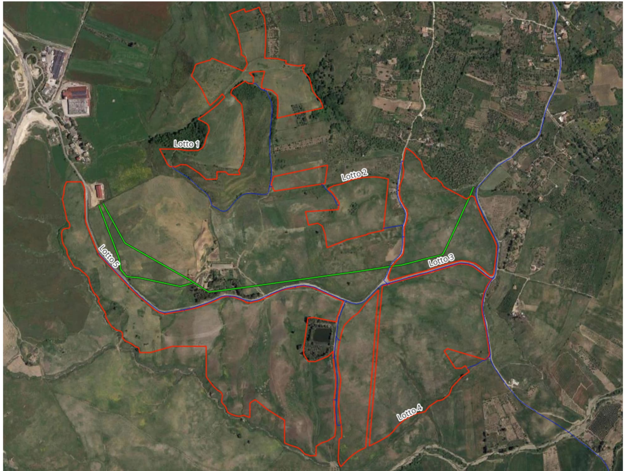
Figura 25 -Linee elettriche presenti nell'area di impianto(in rosso). In verde (fascia di rispetto linee BT).
