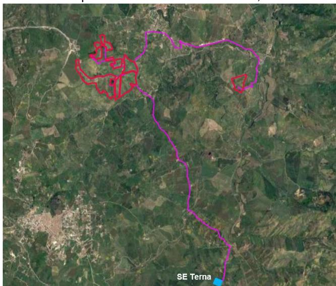
Ubicazione dell'area di impianto (in rosso), del cavidotto di connessione (in magenta) e della stazione di connessione (in azzuro)
