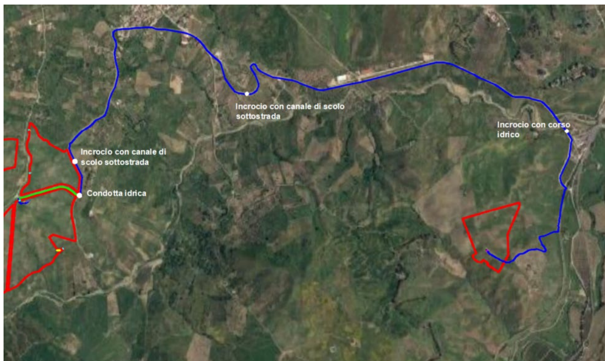
Figura 24 - Inquadramento su ortofoto dell'area di impianto con indicazione della Linea 7 (in blu e in verde) e delle interferenze
