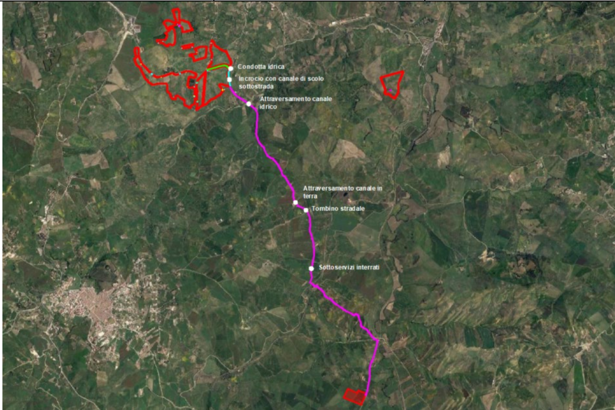
Figura 27 - Inquadramento su ortofoto dell'area di impianto con indicazione del cavidotto di connessione (in magenta, ciano e verde) e delle interferenze
