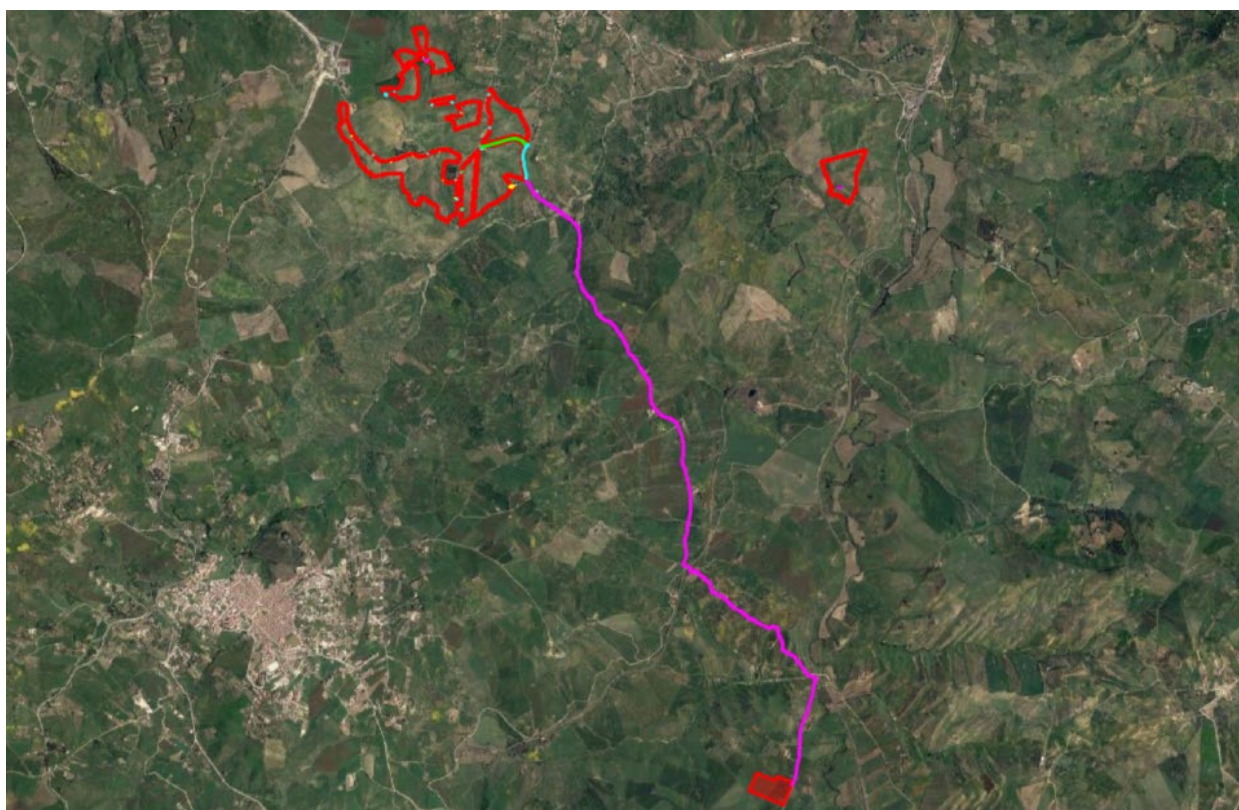
Figura 25 - Inquadramento su ortofoto dell'area di impianto con indicazione del cavidotto di connessione (in magenta, verde e ciano). In verde il tratto del cavidotto di connessione in comune con la Linea 3 e 7 e in ciano il tratto in comune con la sola Linea 3
