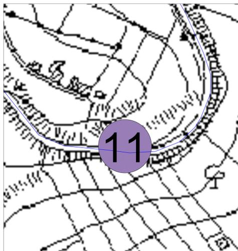
L'attraversamento dell'interferenza lungo il tracciato del cavidotto AT di impianto avverrà mediante posa dei cavidotti sottostrada a profondità ribassata. La posa degli stessi avverrà all'interno di bauletto in cls.
