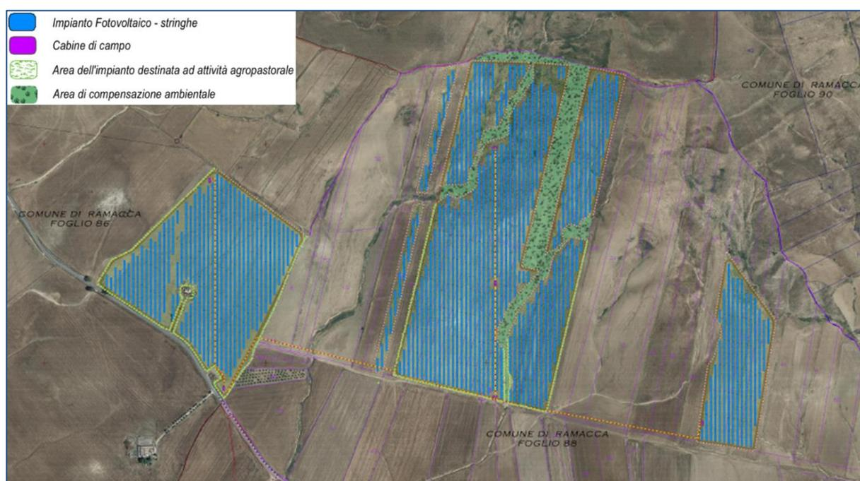
Figura 185: Layout definitivo e aree di mitigazione e/o compensazione (Rif. A12a17 Layout definitivo su cartografia catastale ed ortofoto)
