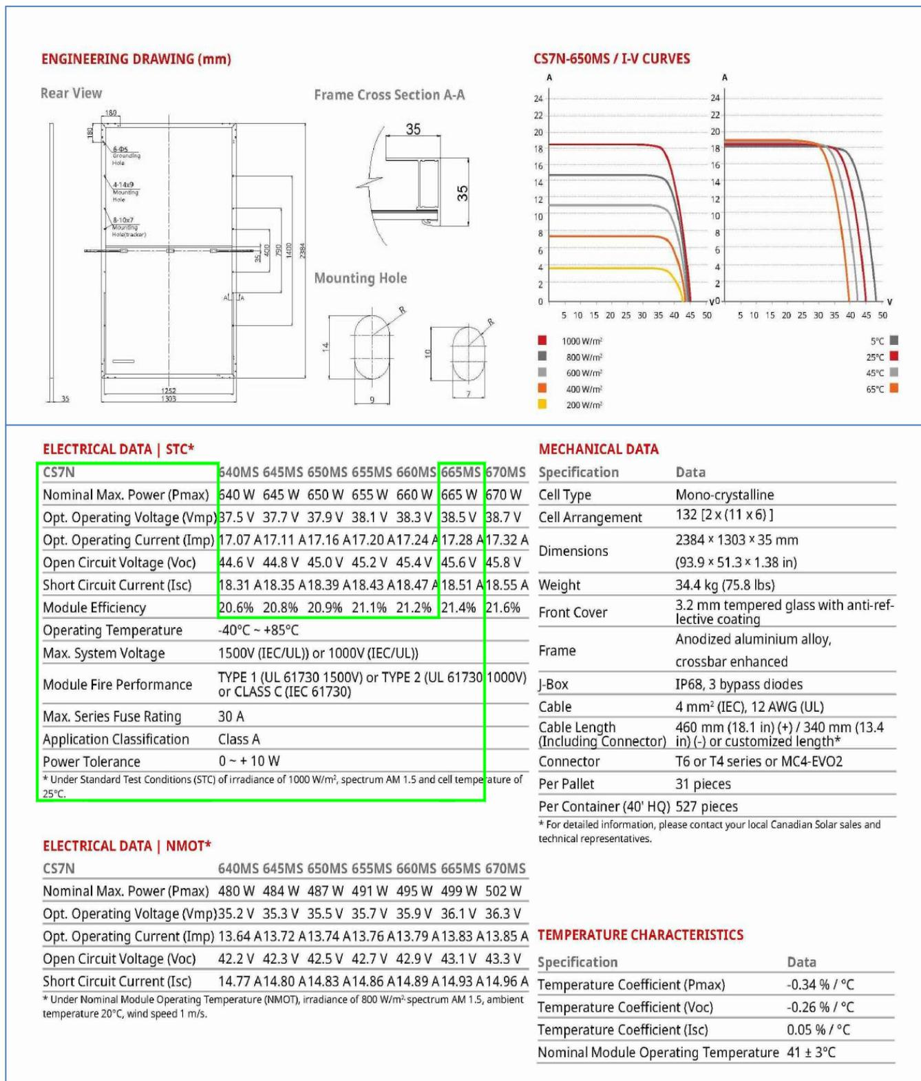
Figura 1: datasheet moduli fotovoltaici
