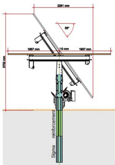
Figura 2 - struttura di sostegno dei pannelli fotovoltaici
