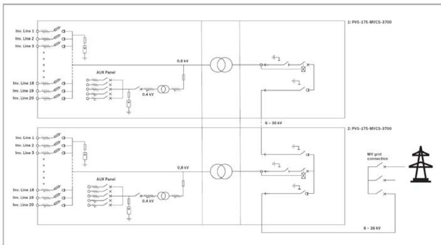
Figura 11: Esempio di diagramma della "PVS-175-MVCS"
