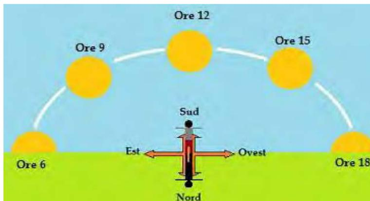
Figura 10: variazione della posizione del tracker e dunque del modulo in funzione delle ore del giorno
