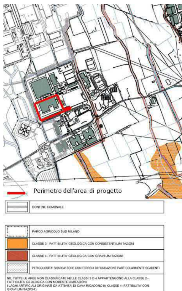
Figura 2-29: Estratto dell'elaborato PR 07 "Aree a pericolosità e vulnerabilità geologica, idrogeologica e sismica e" del PGT del Comune di Settimo Milanese (Variante n.2)
