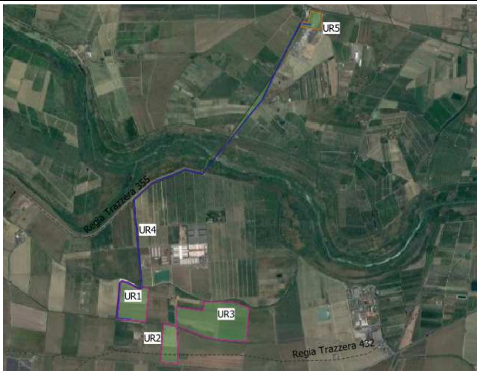
UR4. CAVIDOTTO INTERRATO. INQUADRAMENTO SU MAPPA SATELLITARE.
